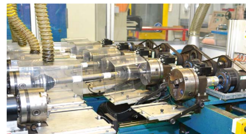
BADANIE KOMPLETNYCH PÓŁOSI NAPĘDOWYCH NA STANOWISKU TESTOWYM
