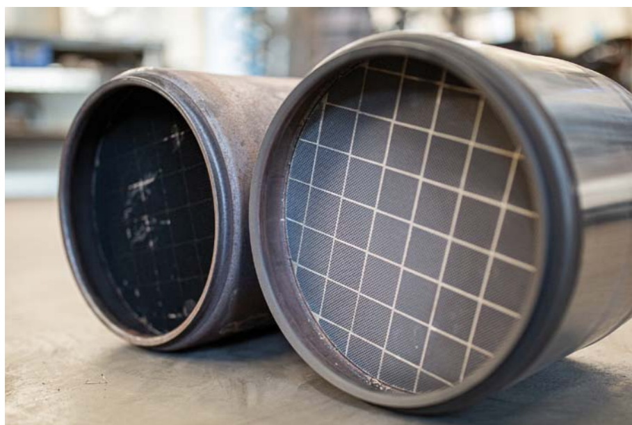
FILTR SAMOCHODU CIĘŻAROWEGO PRZED I PO REGENERACJI
