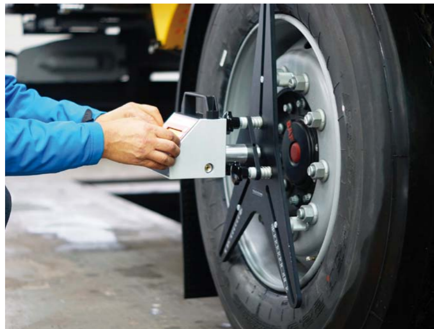
RYS. 4. MOCOWANIE MAGNETYCZNE UCHWYTU GŁOWICY POMIAROWEJ
