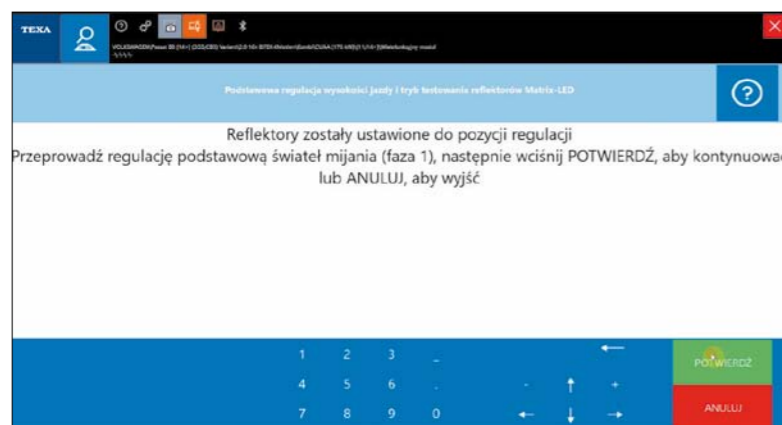
FOT. 6. OPROGRAMOWANIE IDC5 – KALIBRACJA ŚWIATEŁ MIJANIA
