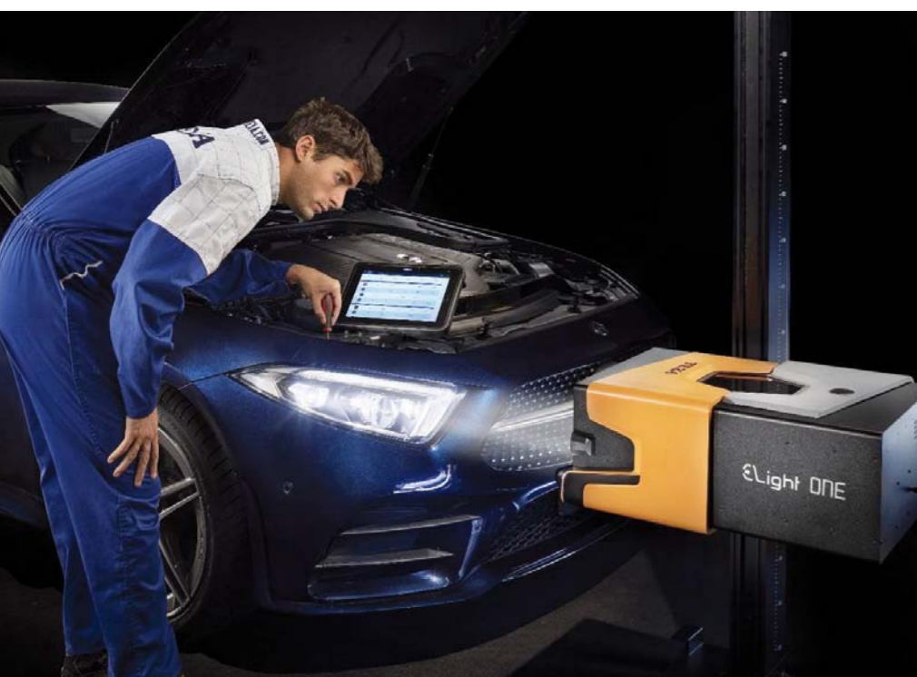
FOT. 1. ZAAWANSOWANY PRZYRZĄD DO POMIARU OŚWIETLENIA POJAZDÓW eLIGHT ONE D
