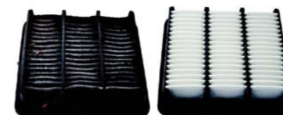
BRUDNY I NOWY FILTR POWIETRZA
