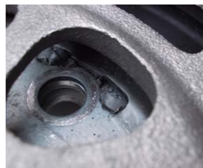
STOPIENIE PŁYTKI FCP PO PRZEBIEGU KILKU TYSIĘCY KILOMETRÓW
