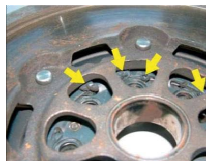
USZKODZONA PŁYTKA NA SKUTEK NIEDOMAGAŃ SILNIKA PUMA
