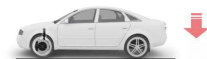
KOŃCOWE DOKRĘCANIE GÓRNEGO ZESTAWU MONTAŻOWEGO ORAZ TULEI PRZEPROWADZA SIĘ NA SAMOCHODZIE DOCIĄŻONYM WŁASNĄ MASĄ
