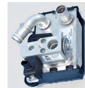
RYS. 3. CHILLER (FIAT 500E)
