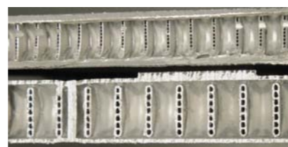
RYS. 2. PRZEKROJE SKRAPLACZY MIKROKANALOWYCH
