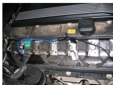
FOT. 1. ADAPTER DO SPRAWDZANIA CEWKI ZAPŁONOWEJ UMIESZCZONEJ NA ŚWIECY (COP)
