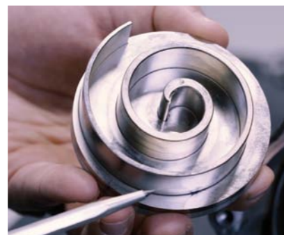
RYS. 1. PRZYKŁAD JEDNEJ CZĘŚCI Z UKŁADU SPIRAL SPRĘŻARKI TYPU SPIRALNEGO
