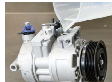
PO NAPEŁNIENIU KOMPRESORA PRZEWIDZIANĄ DLA DANEGO SYSTEMU ILOŚCIĄ OLEJU NALEŻY GO PONOWNIE ZAMKNAĆ
