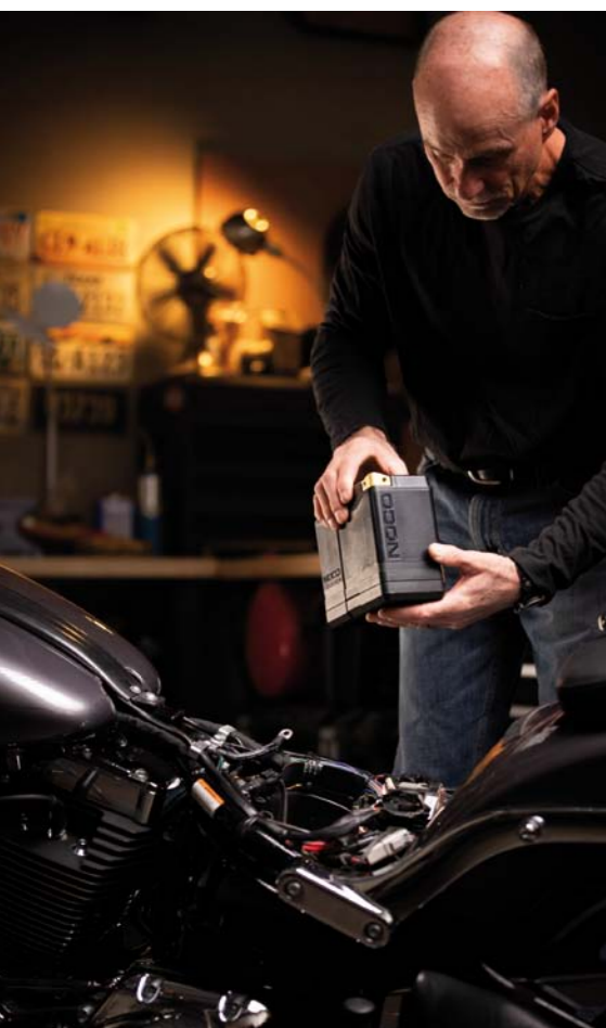
PODSTAWOWYM MODELEM NOCO LITHIUM JEST NLP5 (12 V/2 AH) O WADZE NIESPEŁNA 700 G I GABARYTACH: W PODSTAWIE 113/70 MM, WYSOKOŚĆ 88 MM. JEJĄ PRĄD ROZRUCHOWY WYNOŚI 250 A
