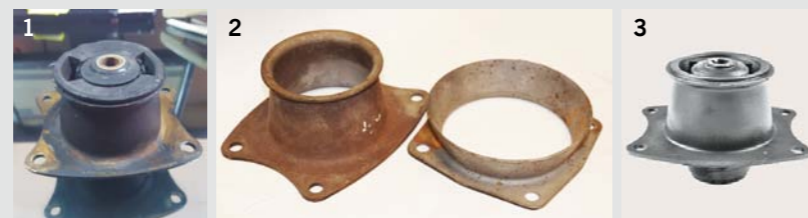
REGENERACJA PODUSZKI SILNIKA DO MERCEDESA 600: 1 – USZKODZONA ORYGINALNA PODUSZKA. 2 – ELEMENTY WYKORZYSTANE W PROCESIE REGENERACJI. 3 – PODUSZKA PO REGENERACJI
