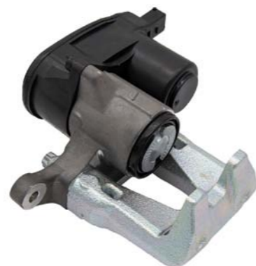
NOWY ZACISK ELEKTRYCZNEGO HAMULCA POSTOJOWEGO MARKI BUDWEG
