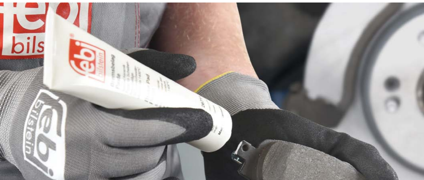
MIEJSCA WSPÓŁPRACY KLOCKA I ZACISKU HAMULCOWEGO NALEŻY PODCZAS MONTAŻU POSMAROWAĆ PASTĄ CERAMICZNĄ, CO ZABEZPIECZY KŁOCEK PRZED ZAPIEKANIEM I ZAPEWNI SWOBODĘ JEGO RUCHU
