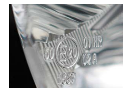
OZNACZENIA HOMOLOGACYJNE NA LAMPIE FERVOR
