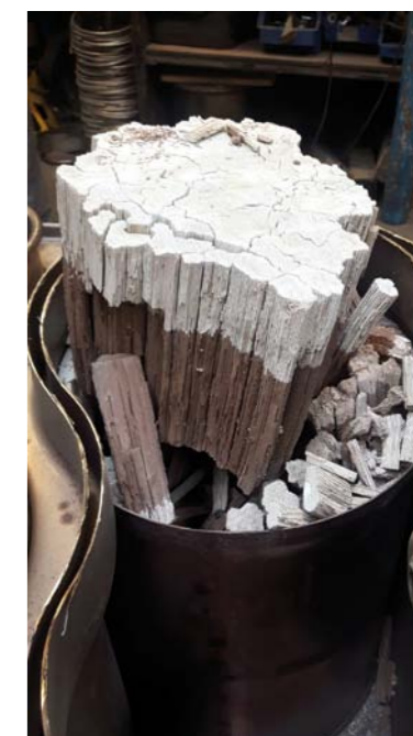
ZNISZCZONY, POKRUSZONY WKŁAD FILTRA DPF
