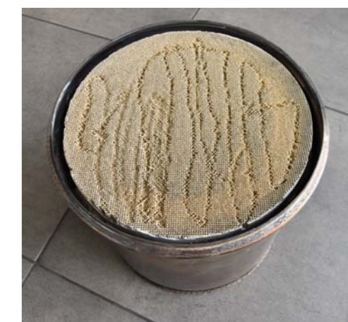
ZNISZCZONY WKŁAD FILTRA. PRAWDOPODOBNIENIE PRZEZ PRÓBĘ UMYCIA MYJKĄ CIŚNIENIOWĄ
