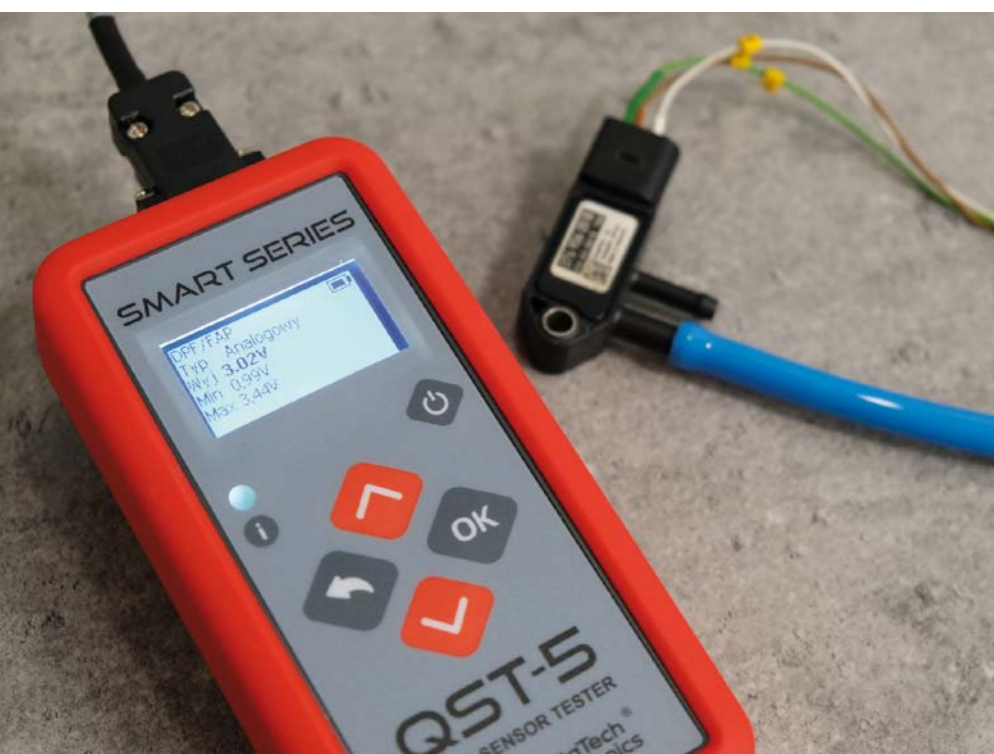
FOT. 1. TESTER QST-5 MOŻE BYĆ WYKORZYSTANY DO BADANIA RÓŻNYCH CZUJNIKÓW
