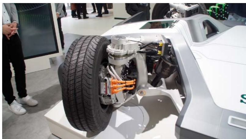
SCHAEFFLER – STEROWANE ELEKTRYCZNIE KOLUMNY ZAWIESZENIA
