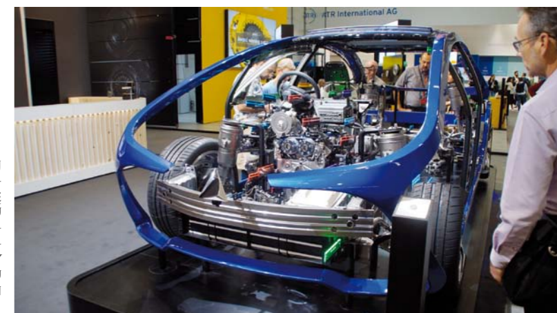
PRZEKRÓJ PRZEZ KON- STRUKCJĘ SAMOCHODU HYBRYDOWE- GO PREZEN- TOWANY NA STOISKU FIRMY AISIN
