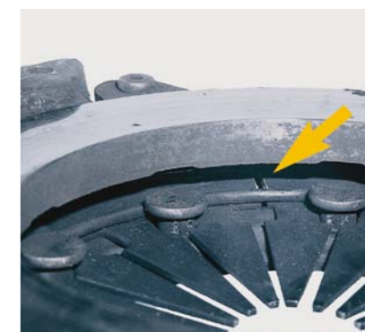
FOT. 7. PĘKNIĘTA SPRĘŻYNA TALERZOWA
