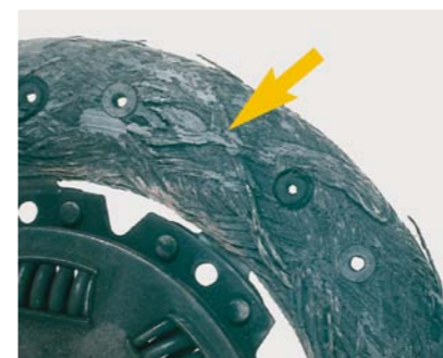
FOT. 3. SPALONA LUB ROZERWANA OKŁADZINA TARCZY SPRZĘGŁA
