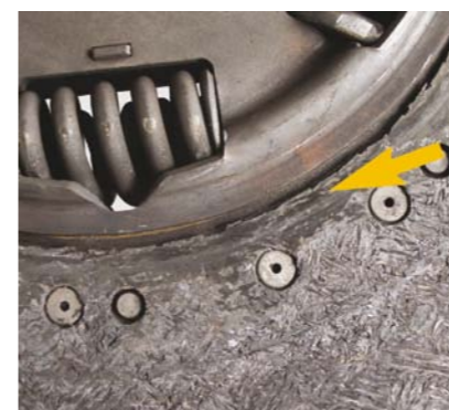
FOT. 2. TARCZA SPRZĘGŁA ZANIECZYSZCZONA OLEJEM LUB SMAREM
