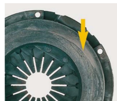
FOT. 4. ŚLADY PRZEGRZANIA DOCISKU SPRZĘGŁA
