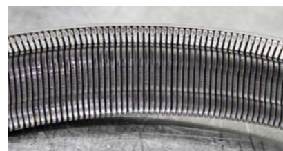
FOT. 3. SKUTKIEM ZUŻYTEGO ZAWÓRU KONTROLI PRZEPŁYWU OLEJU MOGĄ BYĆ USZKODZENIA STOŻKOWYCH BIEŻNI WARIATORÓW ORAZ PASA NAPĘDOWEGO
