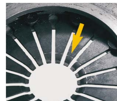
FOT. 6. ZUŻYCIĘ KOŃCÓWEK SPRĘŻYNY TALERZOWEJ DOCISKU SPRZĘGŁA
