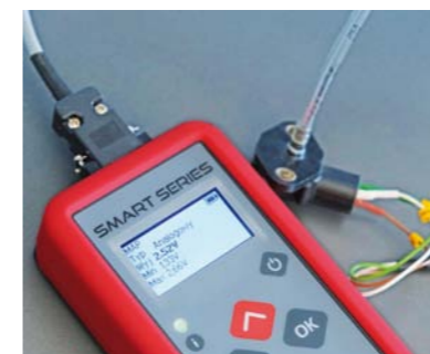
SPRAWDZANIE CZUJNIKA CIŚNIENIA W KOLEKTORZE MAP POZA POJAZDEM
