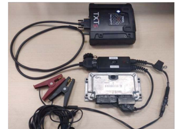
FOT. 6. POŁĄCZENIE STEROWNIKA ADBLUE PRZEWODEM 3151/T70
