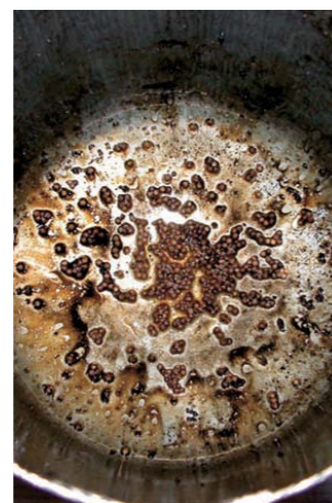
RYS. 15. GRANULAT, WODA I OLEJ WE WKŁADZIE OSUSZACZA POWIETRZA
