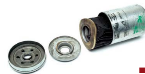
RYS. 7. NIEDROŻNY WKŁAD FILTRUJĄCY SPOWODOWANY ZAPCHANIEM PAPIERU FILTRA
