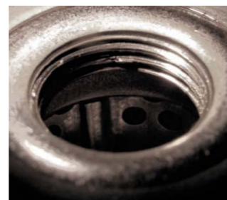
RYS. 5. USZKODZONE ZWOJE GWINTU NA SKUTEK SKOŚNEGO WKRĘCANIA FILTRA
