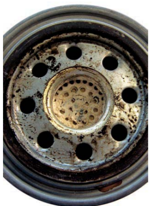
RYS. 13. WYSYP GRANULATU WE WKŁADZIE OSUSZACZA POWIETRZA
