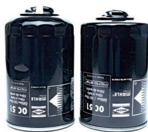
RYS. 2. PORÓWNANIE: USZKODZONY, WYDĘTY FILTR (PO LEWEJ) I NOWY (PO PRAWĘJ)
