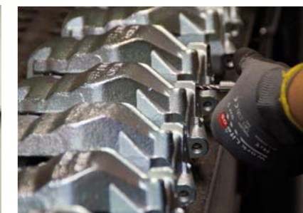
PRZEWINTOWYWANIE OTWORÓW PO GALWANIZACJI
