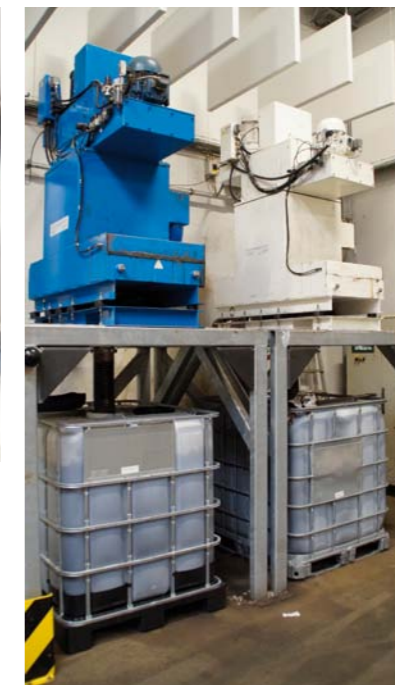
ZAMKNIĘTY OBIEG EMULSJI MYJĄCEJ
