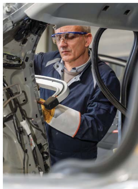
RYS. 5. UŻYCIE ZGRZEWARKI Z UCHWYTEM TYPU „C”
