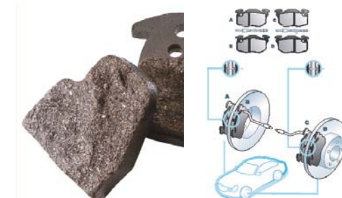
NIEPRAWIDŁOWY MONTAŻ KLOCKÓW (ZACISK TYPU BENDIX IV)
