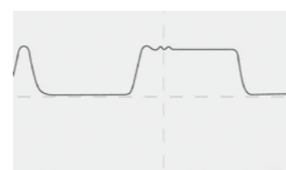
REJESTRACJA SYGNAŁU Z PINU C9 Włączyć zapłon, nacisnąć i zwolnić pedał. Wzrost i spadek wartości sygnału jest zależny od szybkości naciśnięcia i ponownego zwolnienia pedału
