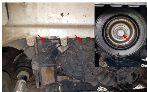
RYS. 2. WSPORNIK NADKOLA, OSŁONA NAPĘDU OSPRZĘTU ORAZ KOŁO PASOWE NAPĘDU OSPRZĘTU (OZNACZENIE STRZAŁKAMI) – PEUGEOT TRAVELLER Z SILNIKIEM 2.0 BHDI
