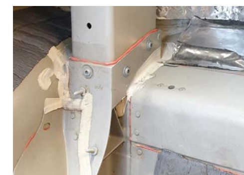
RYS. 6. NITOWANIE UZUPEŁNIONE KLEJENIEM W POŁĄCZENIACH NADWOZIA (TESLA)
