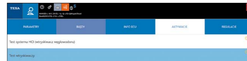
RYS. 1. AKTYWACJA TESTU WTRYSKIWACZY W OPROGRAMOWANIU IDC5 TEXA
