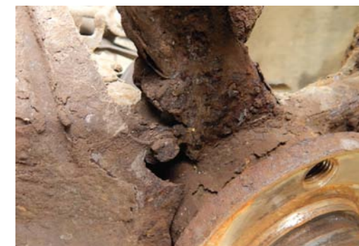
NAJWIĘKSZYM WROGIEM OSŁON TARCZ HAMULCOWYCH JEST KORYZJA
