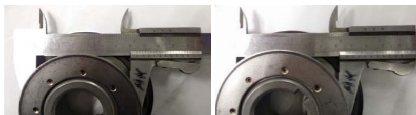
RÓŻNICA ŚREDNIC OWALNEGO KOŁA WAŁU KORBOwego WYNOŚI JEDYNIJE 2 MM
