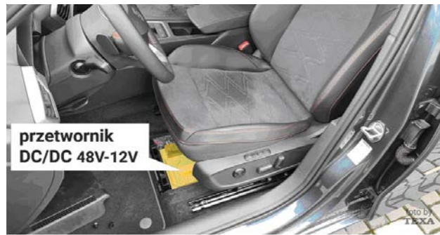
RYS 7. ROZMIESZCZENIE KOMPONENTÓW UKŁADU MIKROHYBRYDOWEGO – PRZETWORNIK DC/DC
