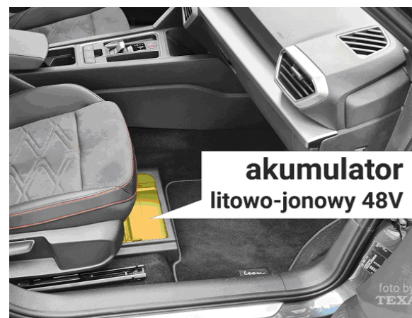
RYS 10. UMIEJSCOWIENIE AKUMULATORA TRAKCYJNEGO UKŁADU MIKROHYBRYDY
