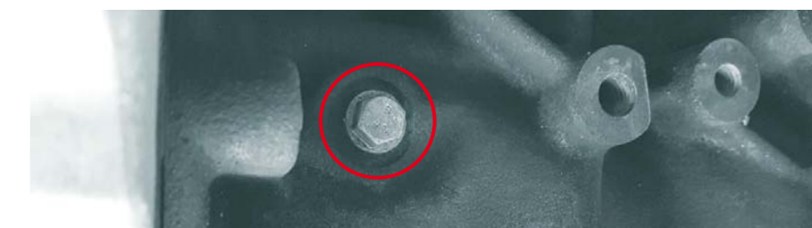
RYS. 7. OTWÓR TECHNOLOGICZNY DO UMIESZCZENIA PRZYRZĄDU SPECJALNEGO OGRANICZAJĄCEGO OBRÓT WAŁEM KORBOWYM W SILNIKACH FORD 1.8 TDCI
