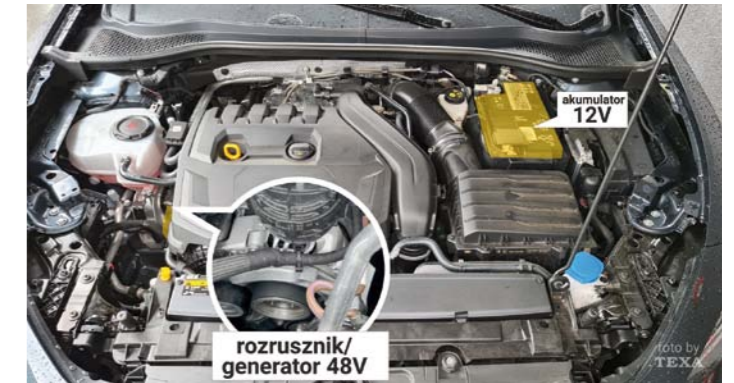
RYS 5. ROZMIESZCZENIE KOMPONENTÓW UKŁADU MIKROHYBRYDOWEGO – ROZRUSZNIK/GENERATOR I AKUMULATOR
