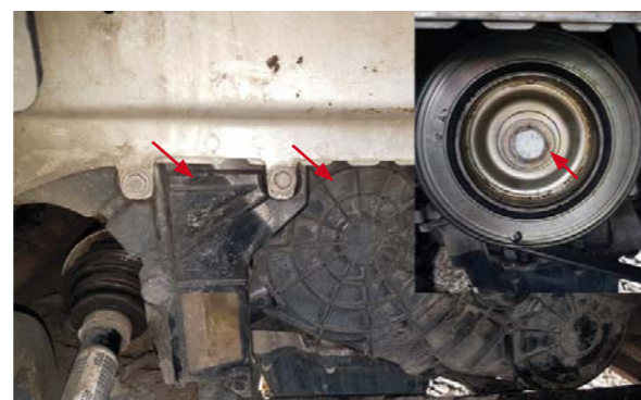
RYS. 2. PEUGEOT TRAVELLER Z SILNIKIEM 2.0 BHD1 – WSPORNIK NADKOLA, OSŁONA NAPĘDU OSPRZĘTU ORAZ KOŁO PASOWE NAPĘDU OSPRZĘTU (OZNACZENIE STRZAŁKAMI)
