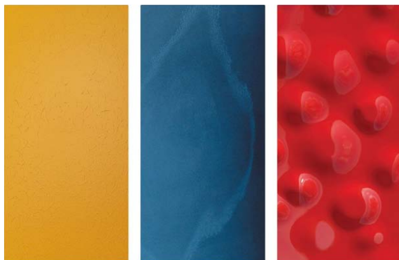
NIEPRAWIDŁOWE USTAWIENIA PISTOLETU MOGĄ DOPROWADZIĆ DO POWSTAWANIA WAD, TAKICH JAK ZACIEKI, CHMURZENIE, SKÓRKA POMARAŃCZY
