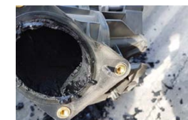
RYS. 7. PRZYKŁAD ZANIECZYSZCZONEGO KOLEKTORA UKŁADU DOLOTOWEGO SILNIKA N47X
