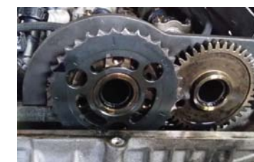
RYS. 4. USTAWIENIE ZĘBATEKI NA KOŁE ZĘBATYM WAŁKA ZAWORÓW DOLOTOWYCH W UKŁADZIE ROZRZĄDU SILNIKÓW N47X (N57X)
