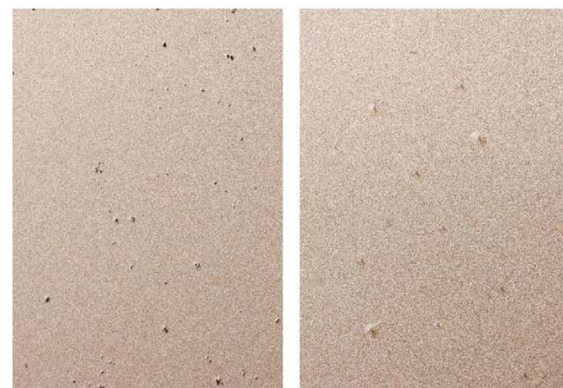
WTRĄCENIA W LAKIERZE BAZOWYM (PO LEWEJ) ORAZ WTRĄCENIA W LAKIERZE BEZBARWNYM (PO PRAWĘJ) SĄ WYNIKIEM NIEZACHOWANIA CZYSTOŚCI PODCZAS PRACY
