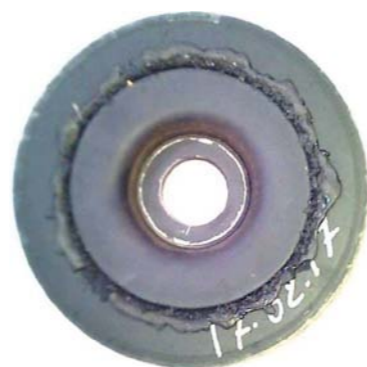
USZKODZONE KOŁO PASOWE
