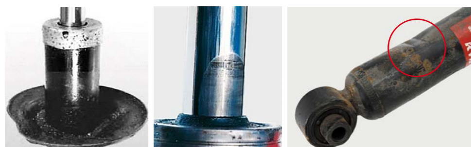
PRZYKŁADY TYPOWYCH USZKODZEŃ AMORTYZATORÓW
