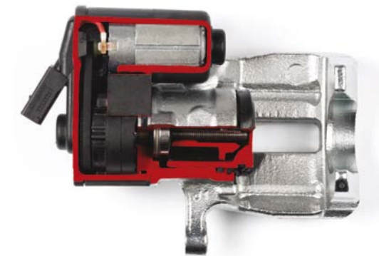
BUDOWA SILNIKA DO ZACISKU HAMULCA POSTOJOWEGO EPB KONSTRUKCJI TRW
