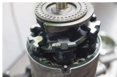
ZANIECZYSZCZENIE ŚRODKIEM USZCZELNIAJĄCYM JEST WIDOCZNE NA PŁYCKIE WYCHYLENEJ I TŁOKACH
