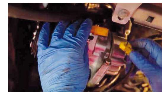
PODCZAS MONTAŻU NALEŻY UŻYWAĆ NOWYCH RĘKAWIC, BY UNIKNĄĆ ZANIECZYSZCZENIA SPRĘŻARKI
