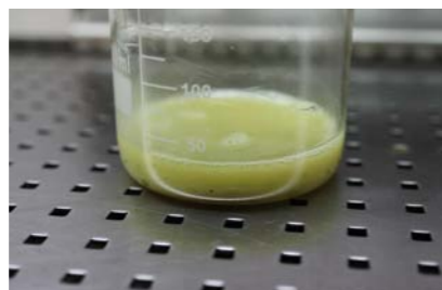
OLEJ ZANIECZYSZCZONY ŚRODKIEM PŁUCZĄCYM – WIDOCZNE MLECZNE PRZEBARWIENIA
