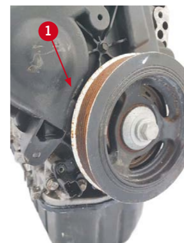
RYS. 3. LOKALIZACJA CZUJNIKA PRĘDKOŚCI OBROTOWEJ SILNIKA 1.6 HDI DV6 ETED: 1 – CZUJNIK PRĘDKOŚCI OBROTOWEJ SILNIKA
