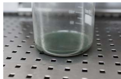
OLEJ O CIEMNOZIELONYM ZABARWIENIU Z POWODU ZBYT DUŻEJ ILOŚCI BARWNIKA UV
