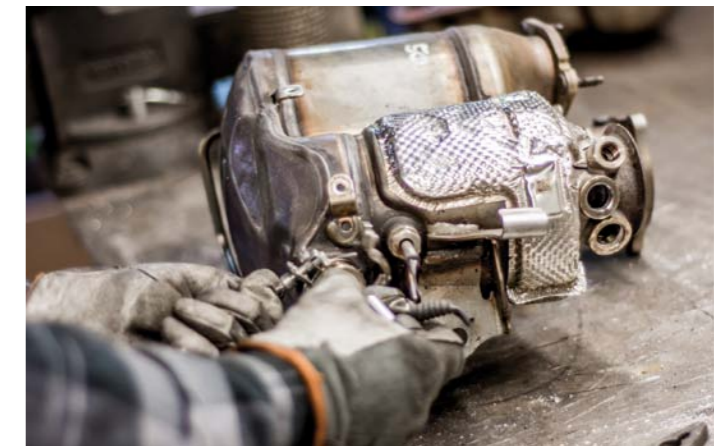
ZDEMONTOWANY FILTR CZĄSTEK STAŁYCH POJAZDU OSOBOWEGO
