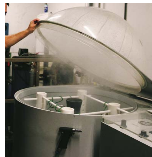
TEST W SOLANCE POZWALA SPRAWDZIĆ ODPORNOŚĆ ZACISKU HAMULCA POSTOJOWEGO NA KOROZJĘ
