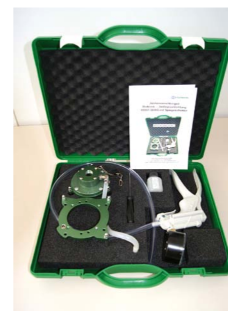
PRAKTYCZNA WALIZKA CSC-KIT RADAR II MIEŚCI PRZYRZĄD KALIBRACYJNY WYPOSAŻONY W LUSTERKO I POZIOMICĘ, DWA PIERŚCIEŃ CENTRUJĄCE, POMPĘ PODCIŚNIENIOWĄ I POTRZEBNE DO MONTAŻU NARZĘDZIA
