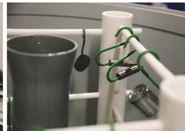
TEST W SOLANCE POZWALA SPRAWDZIĆ ODPORNOŚĆ ZACISKU HAMULCA POSTOJOWEGO NA KOROZJĘ
