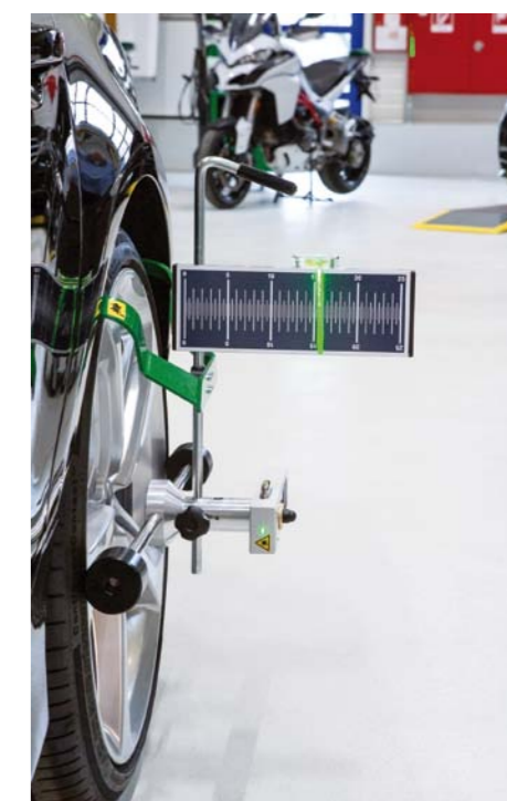
HD-10 EASYTOUCH – UCHWYT NA KOŁO Z ZASILANYM BATERIAMI MODULEM LASERA, WYPOSAŻONY W POZIOMICĘ I SYSTEM MOCOWANIA NA OPONIE POJAZDU
