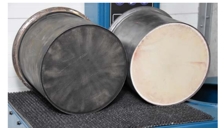
FILTR SAMOCHODU CIĘŻAROWEGO PRZED I PO REGENERACJI
