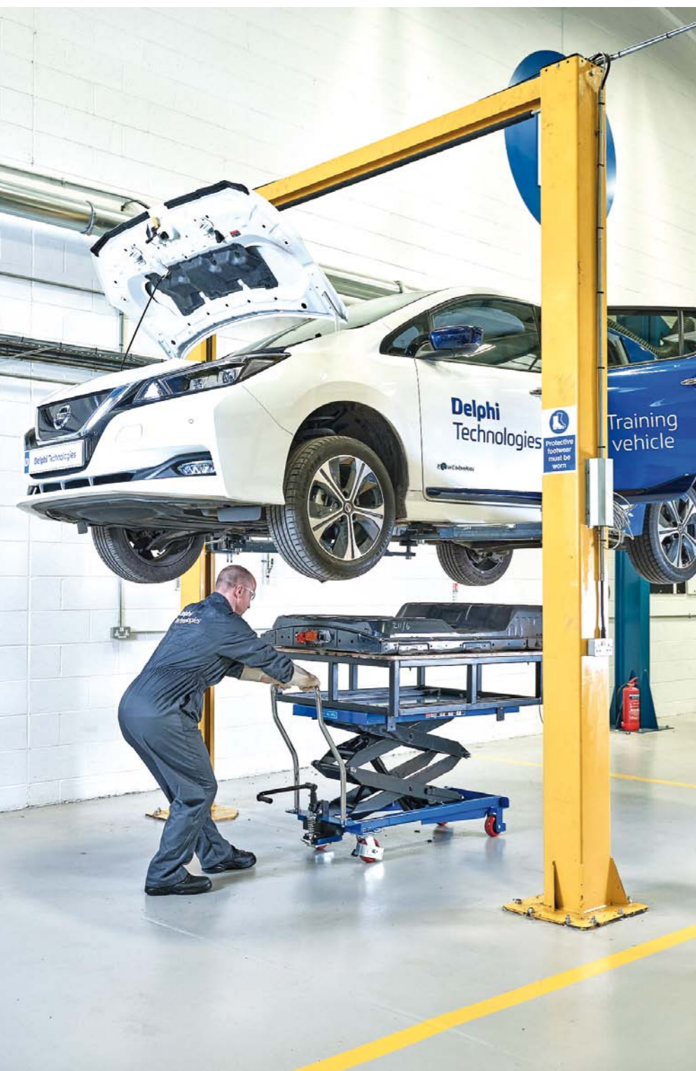
DEMONTAŻ ZESPOŁU AKUMULATORÓW Z POJAZDU NIE JEST CZYNNOŚCIĄ SKOMPLIKOWANĄ. JEDNAK WYMAGA RYGORYSTYCZNEGO PRZESTRZEGANIA PROCEDUR
