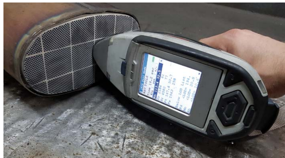
POMIAR PRZEPUSTOWOŚCI FILTRA CZĄSTEK STAŁYCH WYKONYWANY JEST SPECJALISTYCZNYM SPEKTROMETREM
