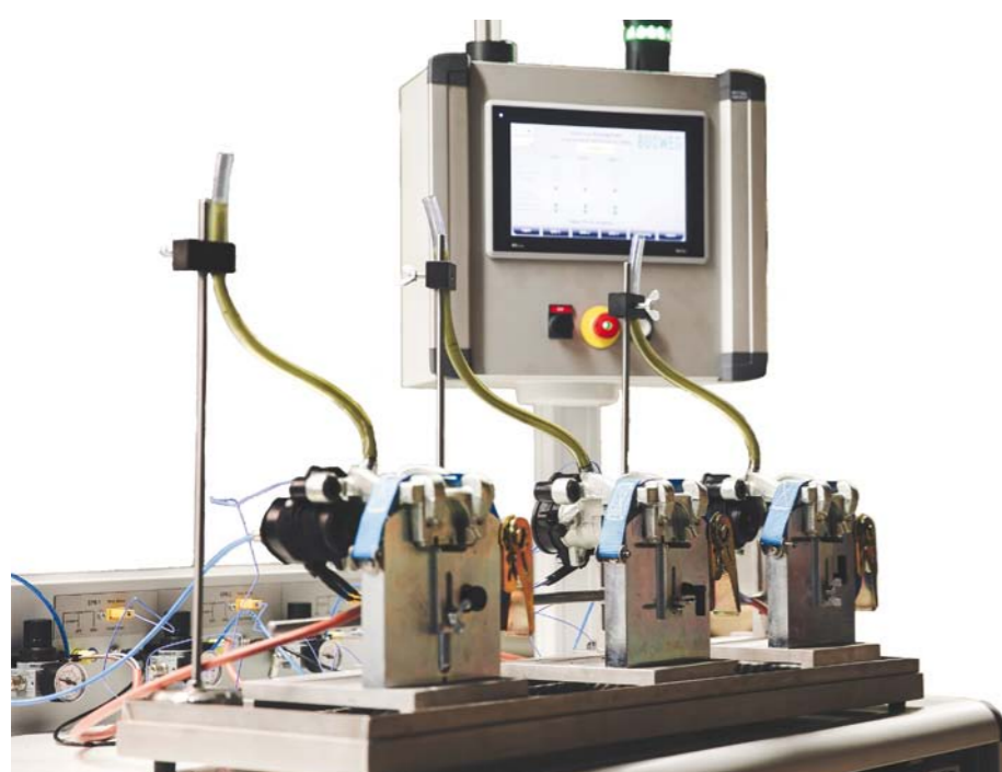
BADANIA ZMĘCZENIOWE ZACISKÓW HAMULCA ELEKTRYCZNEGO
