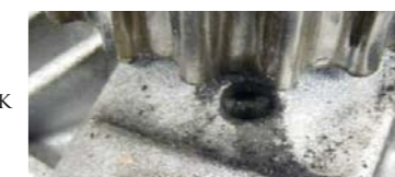
RYS. 2. KONSTRUKCYJNIE ZAKŁADANY WYCIĘK Z POMPY WODY (1 \mu\text{m} = 0.001 mm)
