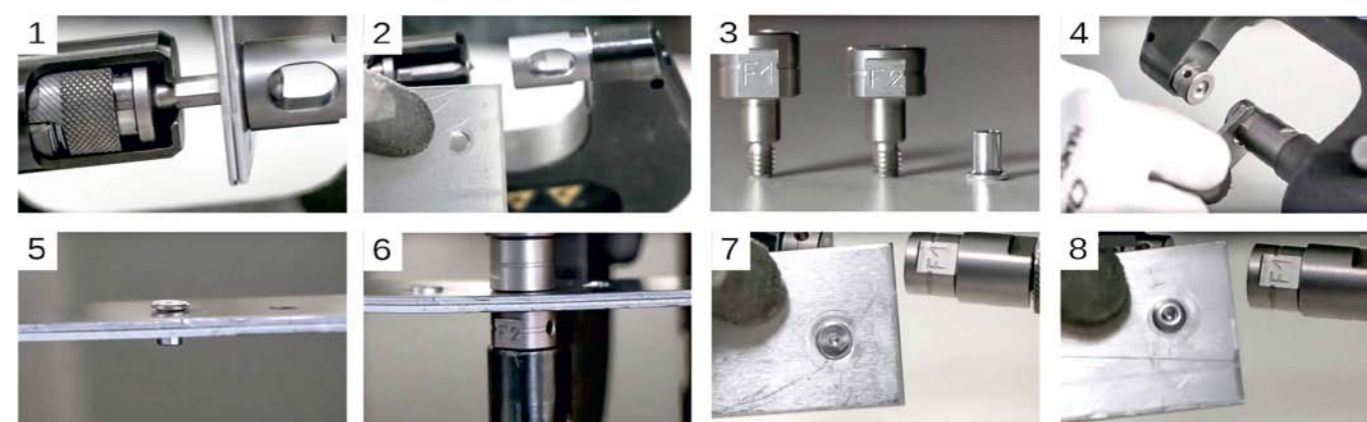
PROCES NITOWANIA KAROSERII (GYS.PL)
