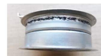
FOT. 5 POZOSTAŁOŚCI PASKA NA ROLCE NAPINĄJĄCEJ
