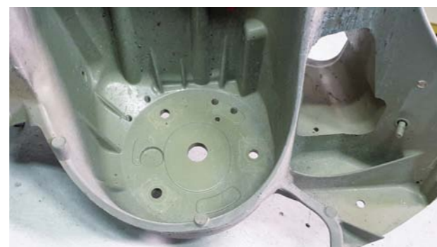
FRAGMENT KAROSERII WYKONANY JAKO ODLEW CIŚNIENIOWY – ELEMENT POCHODZI Z KAROSERII TESLI (BR)
