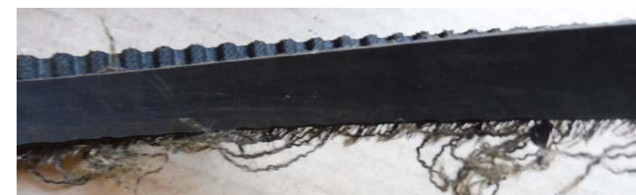
FOT. 3 JEDNOSTRONNIE ŚCIEŹY PASEK
