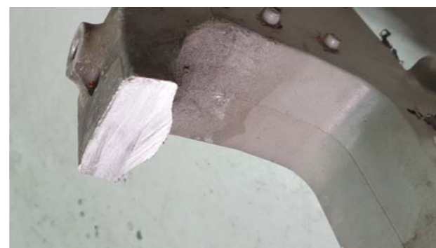
PRZEKRÓJ ELEMENTU NOŚNEGO KAROSERII
