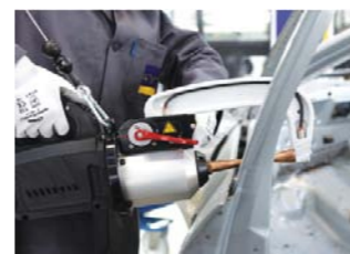
ZGRZEWANIE KAROSERII URZĄDZENIEM O BARDZO WYSOKICH PARAMETRACH Z AUTOMATYCZNYM DOBREM PARAMETRÓW PRACY (GYS.PL)
