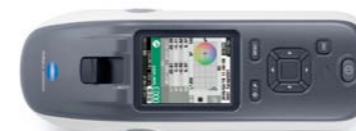
CM-26dG – PRZENOŚNY SPEKTROFOTOMETR ZE SFERYCZNĄ GEOMETRIĄ I POZIOMYM USTAWIENIEM
