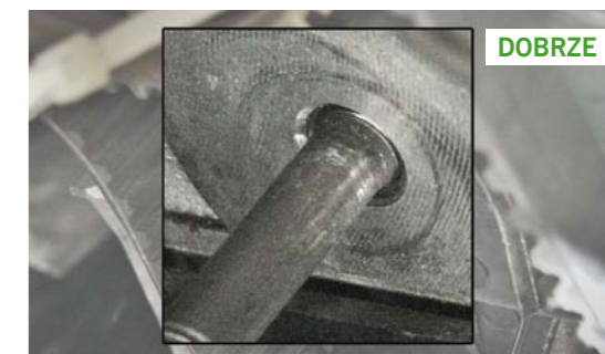
RYS. 6. GWINT NA SZPILCE MUSI ZNAJDOWAĆ SIĘ NA RÓWNI LUB PONIŻEJ POWIERZCHNI BLOKU SILNIKA
