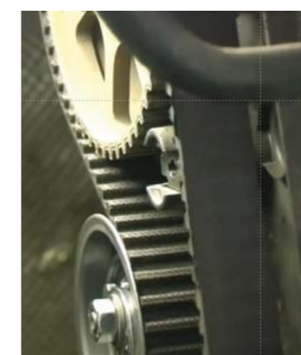
FOT. 4 ZSUNIĘCIE SIĘ PASKA Z KOŁA WAŁKA ROZRZĄDU
