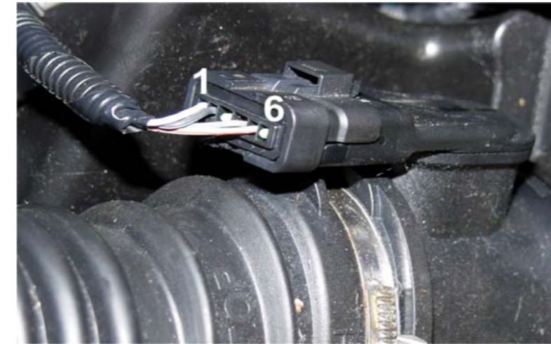
RYS. 3. PRZYKŁADOWE PRZYPISANIE PINÓW CZUJNIKA MAF: PIN 1 – SYGNAŁ CZUJNIKA TEMPERATURY – POWIETRZE DOLOTOWE, PIN 2 – MASA, PIN 4 – ZASILANIE +12 V, PIN 5 – SYGNAŁ MASY POWIETRZA
