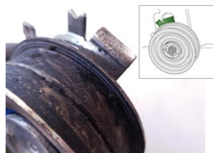
WYPUST POWINIEN SIĘ ZNAJDOWAĆ W ODPOWIEDNIEJ SZCZELINIE
