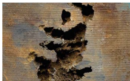
RYS. 1. TULEJA CYLINDROWA Z USZKODZENIAMI KAWITACYJNYMI. OSTRE KRAWĘDZIE WZORÓW WIDOCZNE SĄ W POWIĘKSZENIU PO PRAWEJ STRONIE
