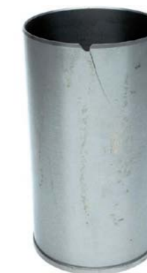
RYS. 5. CZĘŚĆ KOŁNIERZOWA TULEI CYLINDROWEJ Z WIDOCZNYM PĘKNIĘCIEM WZDŁUŻNYM
