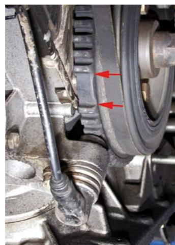
FOT. 2. KOŁO ENKODERA NA KOLE PASOWYM SILNIKA BMW (M40)
