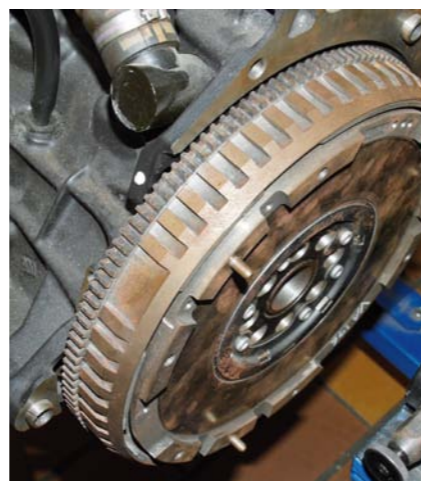
FOT. 3. KOŁO ENKODERA NA KOLE ZAMACHOWYM SILNIKA PEUGEOT (DW10)
