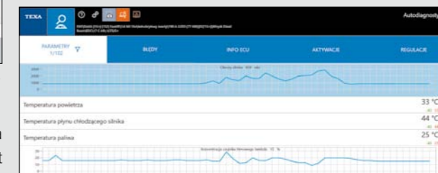
RYS. 9. PARAMETRY PRACY NOWEJ SONDY LAMBDA PO WYMIANIE I ADAPTACJI
