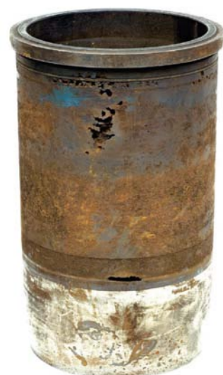
RYS. 1. TULEJA CYLINDROWA Z USZKODZENIAMI KAWITACYJNYMI. OSTRE KRAWĘDZIE WZORÓW WIDOCZNE SĄ W POWIĘKSZENIU PO PRAWEJ STRONIE
