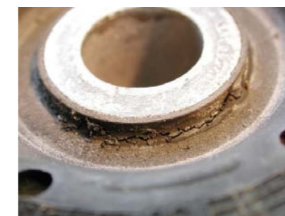
WADLIWE ŁOŻYSKO OPOROWE AMORTYZATORA Z PIERWSZYMI OBJAWAMI PĘKNIĘĆ NA POWIERZCHNI GUMY
