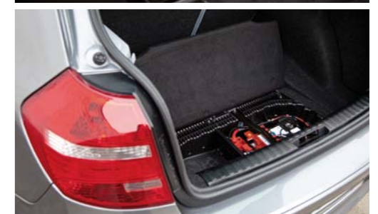
LOKALIZACJA AKUMULATORA W NIEKTÓRYCH MODELACH SAMOCHODÓW JEST NIETYPOWA
