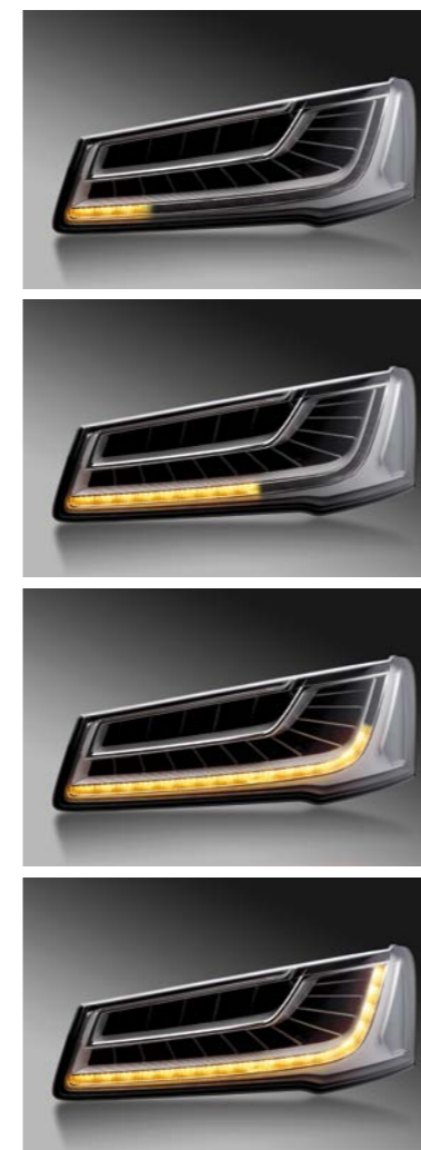
ORYGINALNY KIERUNKOWSKAZ W FORMIE DYNAMICZNIE PRZEPEŁYWAJĄCEJ LINII ŚWIETLNEJ ZNALAZŁ ZASTOSOWANIE W NADWOZIU AUDI
