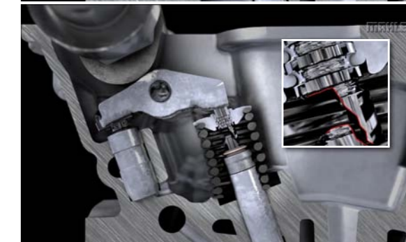
RYŚ. 7. ZERWANIE ZAWORU JAKO EFEKT UKOŚNIE ZAŁOŻONEJ SPRĘŻYNY
