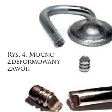
RYŚ. 5. ZŁAMANA W ROWKU STOPA ZAWORU (PRZEŁOM STATYCZNY – NAPRĘŻENIE ZGINAJĄCE)
