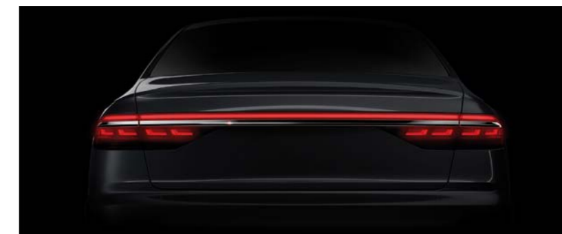
KOMPOZYCJA TYLNYCH LAMP WYPRODUKOWANYCH PRZEZ HELLĘ W TECHNOLOGII OLED ZASTOSOWANA W AUDI A8
