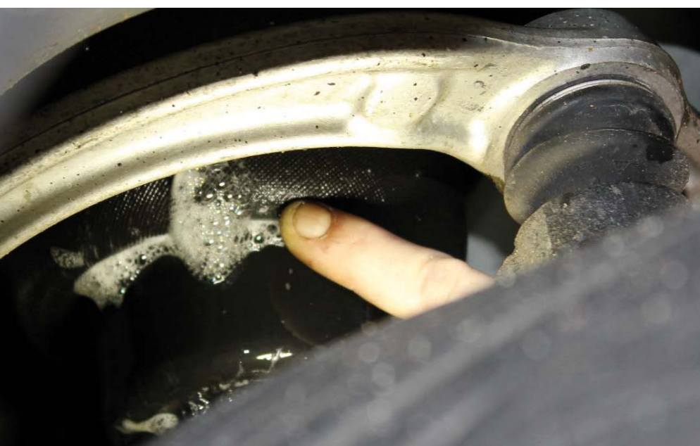
WYKRYWANIE NIESZCZELNOŚCI MIECHA
