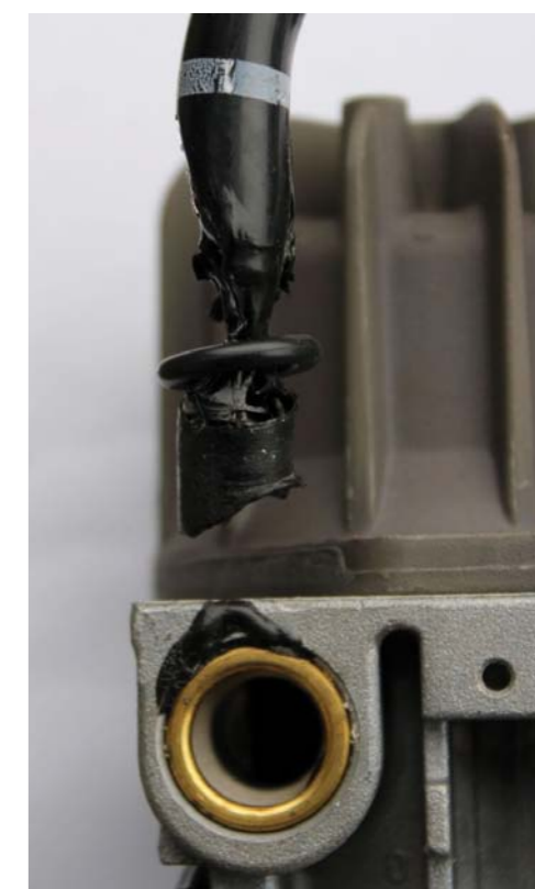
USZKODZONY PRZEWÓD DOŁOTOWY SPRĘŻARKI
