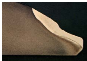
RYS. 12. SILNIE ZUŻYTA POWIERZCHNIA USZCZELNIENIA
