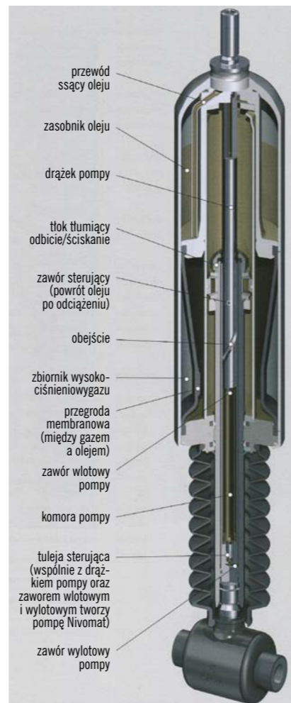
NIVOMAT – BUDOWA I CZĘŚCI SKŁADOWE
