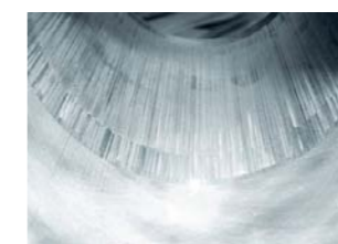
FOT. 10. RYSY I ZATARCIA NA BIEŻNI ŚLIZGOWEJ CYLINDRA
