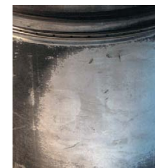
FOT. 8. SZEROKI ŚLAD DOLEGANIA I RYSY SPOWODOWANE ROZCIEŃCZENIEM PRZEZ PALIWO
