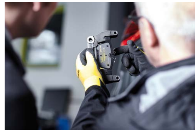
JEŻELI USUWANY KLOCEK HAMULCOWY MA NAKŁADKĘ TŁUMIĄCĄ, TO MONTOWANY RÓWNIEŻ POWINIEN JĄ MIEĆ
