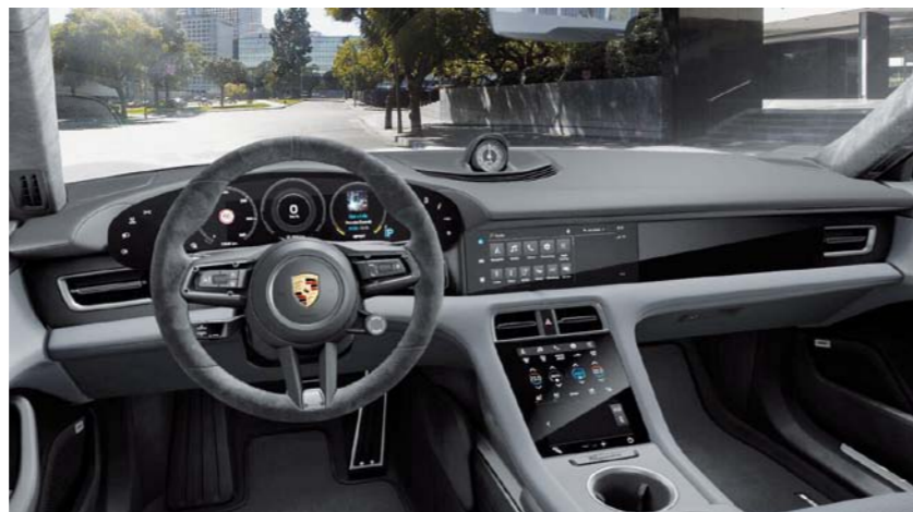
STANOWISKO KIEROWCY SPRAWIA IMPONUJĄCE WRAŻENIE. KILKA KONFIGUROWALNYCH EKRANÓW. BRAK TRADYCYJNYCH PRZYCISKÓW I POKRĘTEŁ. ZASTĄPIONYCH PRZEZ PANELE CYFROWE DO OBSŁUGI ŚWIATEŁ, FUNKCJI PODWOZIA, AUDIO, NAWIGACJI I ŁĄCZNOŚCI
