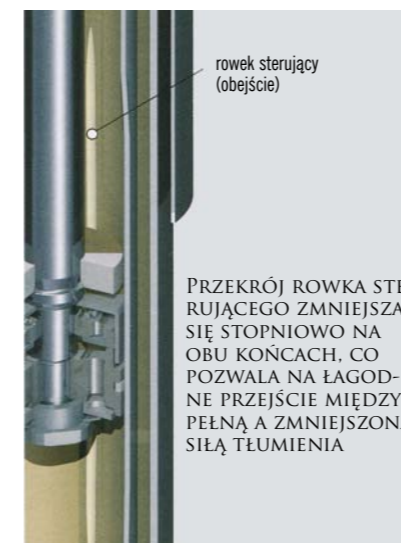
BUDOWA AMORTYZATORA DWURUROWEGO
