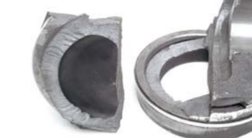
FOT. 13. TŁOK POJAZDU UŻYTKOWEGO ZNISZCZONY PRZEZ UDERZENIE CIECZY
