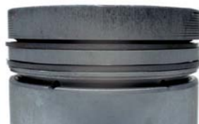
FOT. 4. ZUŻYCIE OSIOWE PIERŚCIENI TŁOKOWYCH
