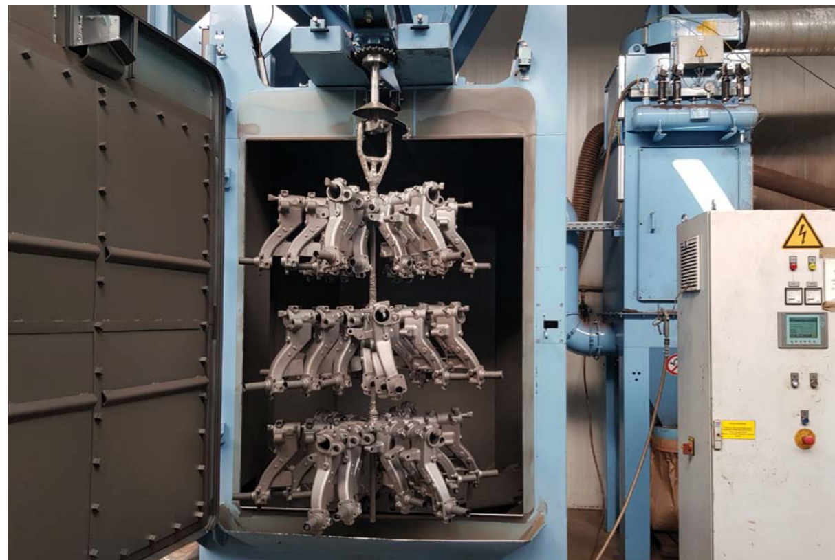
ELEMENTY BELEK OCZYSZCZANE SĄ STRUMIENIOWO W ŚRUTOWNICACH
