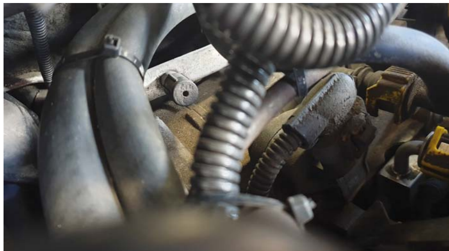
FOT. 4 ZŁĄCZKA SERWISOWA – ZAŚLEPKA CHRONI ZAWOREK PRZED OSADZANIEM SIĘ ZANIECZYSZCZEŃ
