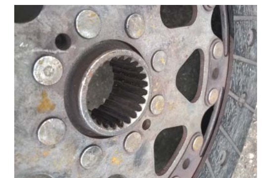
FOT. 3. WYPRACOWANY WIELOKLIN ZDEMONTOWANEJ TARCZY
