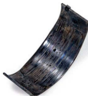
FOT. 14. MOCNO ZUŻYTE I ZDEFORMOWANE ŁOŻYSKO ŚLIZGOWE
