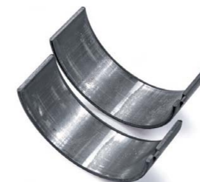
FOT. 7. ZUŻYTE ZEWNĘTRZNE KRAWĘDZIE PANEWEK
