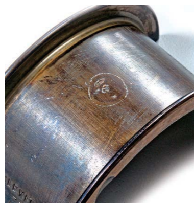
FOT. 3. ODCISK CIAŁA OBCEGO PO ZEWNĘTRZNEJ STRONIE ŁOŻYSKA ŚLIZGOWEGO
