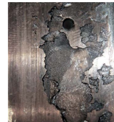
FOT. 18. USZKODZONA POWIERZCHNIA GŁADZI W POWIĘKSZENIU
