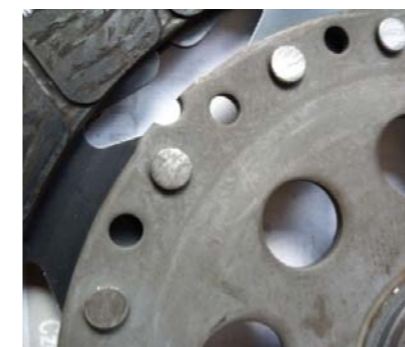
FOT. 1. STARTE NITY TARCZY SPRZĘGŁOWEJ
