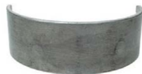
FOT. 16. ODWROTNIE ZAMONTOWANE ŁOŻYSKO ŚLIZGOWE PO STRONIE ZEWNĘTRZNEJ – ODCIŚNIĘTE OTWORY ZASILANIA OLEJEM
