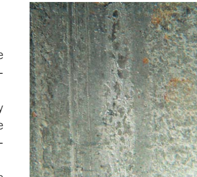
FOT. 19. OBRAZY BIEŻNI ŁOŻYSKA WYTRAWIONYCH PRZEZ AGRESYWNE SUBSTANCJE CHEMICZNE ZAWARTE W OLEJU
