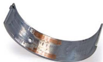
FOT. 10. NIERÓWNOMIERNE ZUŻYCIE NA PANEWKACH ŁOŻYSKA – WARSTWA ŚLIZGOWA CZĘŚCIOWO STARTA
