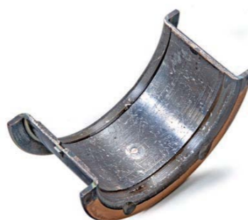
FOT. 2. ŚLADY ZATARCIA NA ŚRODKU ŁOŻYSKA ŚLIZGOWEGO
