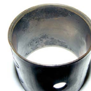
FOT. 20. USZKODZONA TULEJKA KORBOWODOWA
