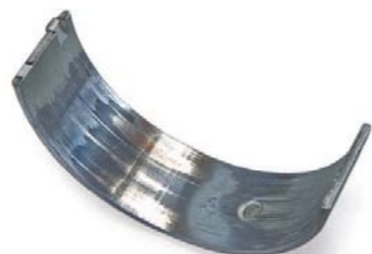
FOT. 11. NIEREGULARNE ZUŻYCIE NA PANEWKACH ŁOŻYSKA
