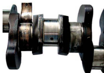
FOT. 15. ŁOŻYSKA ŚLIZGOWE ZESPRAWANE Z WAŁEM KORBOWYM
