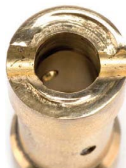
FOT. 6. OBRÓCONA TULEJA ŁOŻYSKOWA
