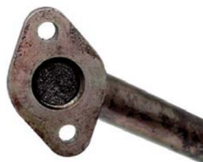
FOT. 12. PRZEWÓD POWROTNY OLEJU ZANIECZYSZCZONY NAGAREM
