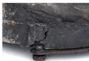
FOT. 18. PĘKNIĘCIE KORPUSU TURBINY
