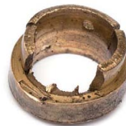
FOT. 7. ZNISZCZONE ŁOŻYSKO PROMIENIOWE
