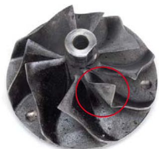
FOT. 17. USZKODZONA TYLKO JEDNA ŁOPATA WIRNIKA SPRĘŻARKI
