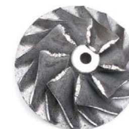
FOT. 15. WIRNIK SPRĘŻARKI USZKODZONY PRZEZ CIAŁA OBCE
