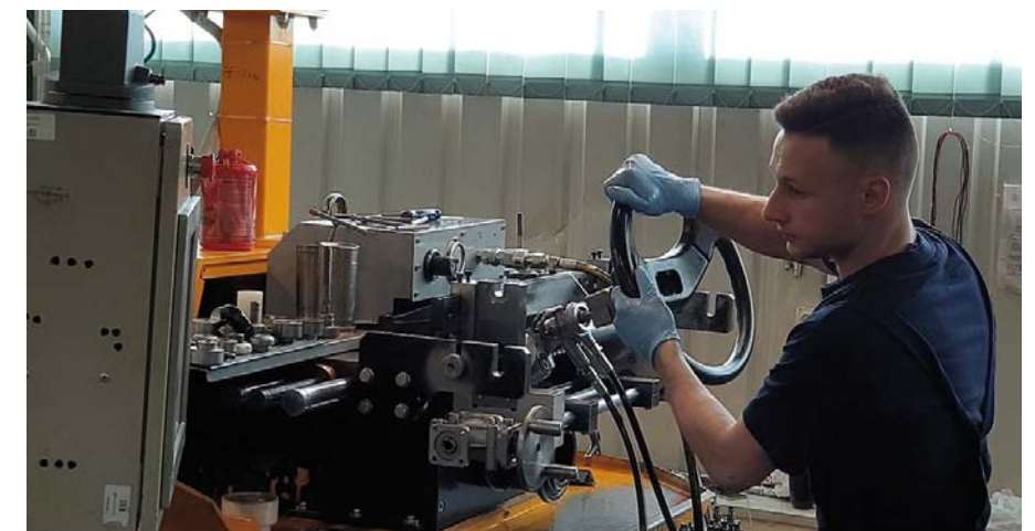
TEST JAKOŚCI ZREGENEROWANEJ PRZEKŁADNI KIEROWNICZEJ
