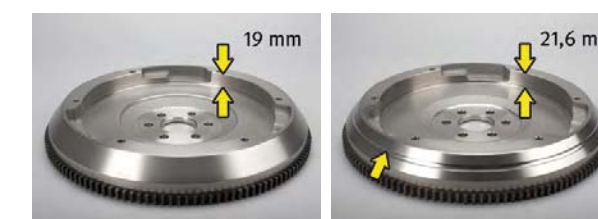
NR OE 90536140 / 616169 BEZ OBWODOWEGO NACIĘCIA. GŁĘBOKOŚĆ KOŁA 19 MM NR OE 93286460 / 5616016 Z OBWODOWYM NACIĘCIEM. GŁĘBOKOŚĆ KOŁA 21,6 MM
