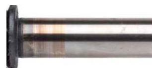
FOT. 4. NAPAWANY NA WAŁKU MATERIAŁ ŁOŻYSKA
