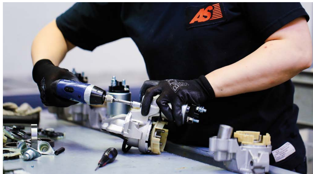
DEMONTAŻ I MONTAŻ PODZESPOŁÓW PRZEPROWADZANY JEST RĘCZNIE
