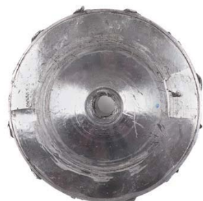
FOT. 19. WGNIECENIA OD TYŁU WIRNIKA SPRĘŻARKI
