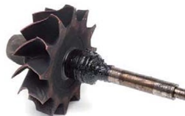
FOT. 11. NAGAR OLEJOWY PO STRONIE TURBINY
