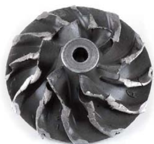
FOT. 1. WIRNIK SPRĘŻARKI PO UDERZENIU W KORPUS
