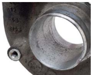
FOT. 16. UDERZENIA CIAŁ OBCYCH W KANAŁE SSĄCYM KORPUSU SPRĘŻARKI
