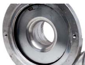
FOT. 2. ŚLADY TARCIA W KORPUSIE SPRĘŻARKI
