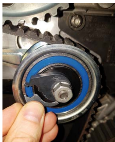
FOT. 1. PĘKNIĘTY I ZEPSUTY REGULATOR
