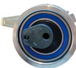
FOT. 2. T43245 PRZED MONTAŻEM. WIDOCZNY OTWÓR MONTAŻOWY I OTWÓR „HEX”
