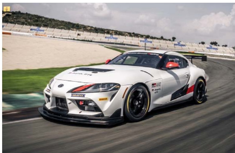
PRZEDNI DYFUZOR I TYLNE SKRZYDŁO TOYOTY GR SUPRA GT4 WYKONANE JEST Z KOMPOZYTÓW ZAWIERAJĄCYCH WŁÓKNA LNU I KONOPI
