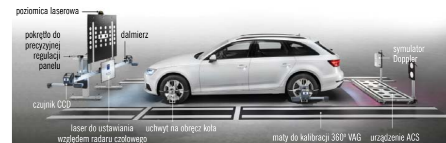
FOT. 3. SYSTEM RCCS2 STOSOWANY JEST W POŁĄCZENIU Z BOCZNYMI MATAMI DLA KAMER 360°, PANELEM KALIBRACYJNYM DLA KAMER TYLNYCH ORAZ URZĄDZENIEM KALIBRACYJNYM DLA RADARU MARTWEGO POLA
