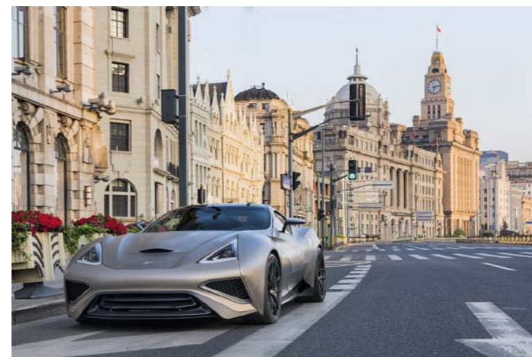
NADWOZIE VULCANO TITANIUM ZOSTAŁO PRAWIE W CAŁOŚCI WYKONANE Z TYTANU
