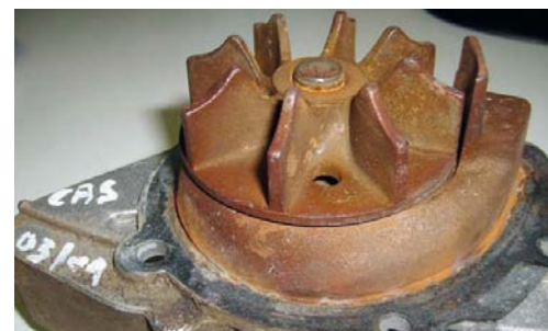
RYS. 3. KORYZJA W UKŁADZIE CHŁODZENIA
