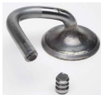
FOT. 4. ZŁAMANY ZAWÓR
