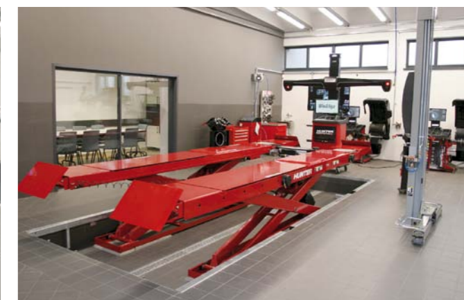
POMIAR I REGULACJA GEOMETRII USTAWIENIA KÓŁ I OSI POJAZDÓW ODBYWA SIĘ NA JEDNOSEKCYJNYM ZAGŁĘBIANYM DŹWIGNIKU NOŻYCOWYM ZA POMOCĄ URZĄDZENIA HUNTER 3D ELITE
