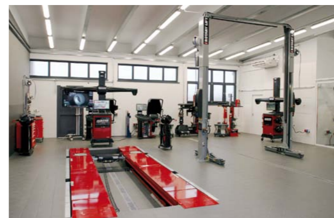
POMIAR I REGULACJA GEOMETRII USTAWIENIA KÓŁ I OSI POJAZDÓW ODBYWA SIĘ NA JEDNOSEKCYJNYM ZAGŁĘBIANYM DŹWIGNIKU NOŻYCOWYM ZA POMOCĄ URZĄDZENIA HUNTER 3D ELITE
