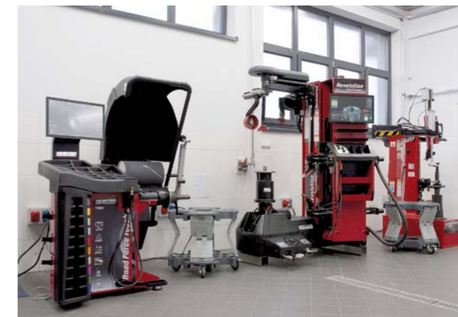
STANOWISKO DO OBSŁUGI KÓŁ WYPOSAŻONE JEST MIĘDZY INNYMI W WYWAŻARKĘ Z TESTEM DROGOWYM HUNTER RFE 20E ORAZ AUTOMATYCZNA I AUTONOMICZNA MONTAŻOWNICĘ HUNTER TCR1XE-435
