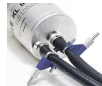
FOT. 10. ODEŁĄCZENIE PRZEWODÓW ZAPOBIEGA WNIKNIĘCIU POWIETRZA DO UKŁADU PALIWOWEGO
