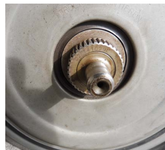
FOT. 4. WYEKSPLOATOWANE ZĘBY MODUŁU SPRZĘGŁA
