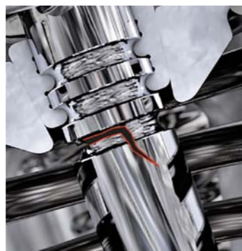
FOT. 2. PĘKNIĘCIE ZAWORU W OKOLICY NAJNIŻSZEGO ROWKA
