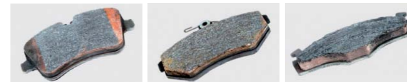
FOT. 3. KLOCKI PRZEGRZANE W TEMPERATURZACH KOLEJNO: 570°C, 700°C I 900°C
