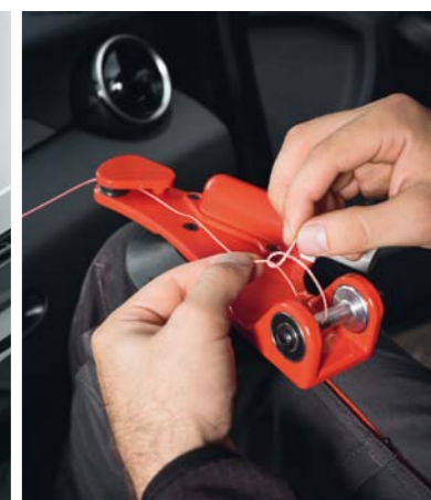
WYCINANIE SZYBY PRZY UŻYCIU MINIZESTAWU (Z LEWEJ) I MOCOWANIE SZNURA TNĄCEGO DO NARZĘDZIA SŁUŻĄCEGO DO WYCINANIA (ART. NR 0714 58 230)
