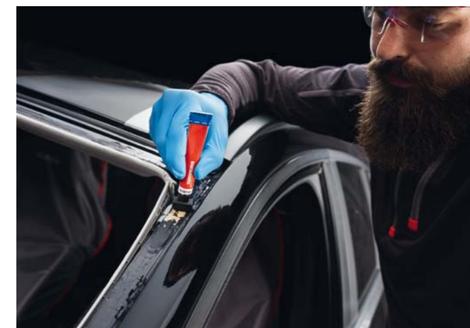
NAKŁADANIE PODKŁADU 4W1 NA SZYBĘ ORAZ POWIERZCHNIĘ DOCIĘTEGO KLEJU NA KAROSERII (ART. NR 0890024010)
