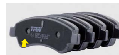
FOT. 4. ELEMENTAMI WYTŁUMIAJĄCYMI NA BLASZCE KLOCKA MOGĄ BYĆ: GRUBSZA WARSTWA FARBY, KLEJU LUB SPECJALNA PŁYTKA
