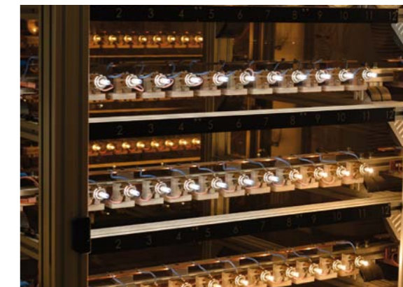
DŁUGOTERMINOWY TEST ŚWIECENIA ŻARÓWKI
