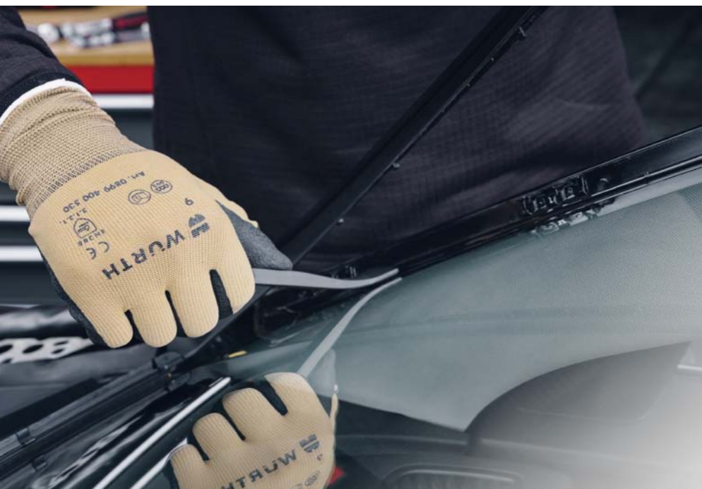
DEMONTAŻ PLASTIKOWYCH ELEMENTÓW ZA POMOCĄ KLINÓW MONTAŻOWYCH (ART. 0714 58 216)
