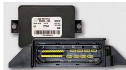
FOT. 11. POŁOŻENIE PINÓW W STEROWNIKU EPB
