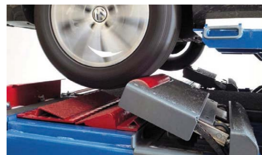
FOT. 9. SPRAWDZANIE MOMENTU HAMOWANIA PODCZAS BADANIA TECHNICZNEGO SAMOCHODU WYPOSAŻONEGO W EPB
