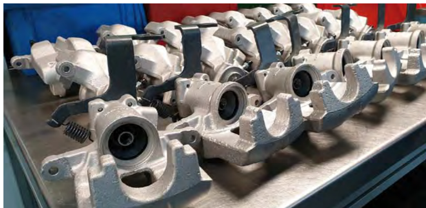
KORPUSY ZACISKÓW Z GALWANICZNIE NAŁOŻONĄ POWŁOKĄ CYNKOWĄ
