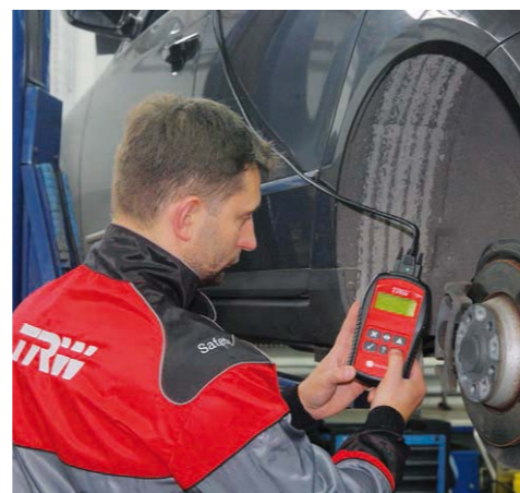
FOT. 13. WYMIANA KLOCKÓW HAMULCOWYCH W ELEKTRYCZNIE STEROWANYM ZACISKU HAMULCOWYM
