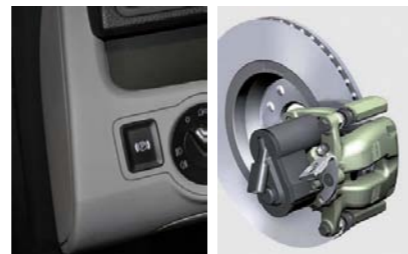
FOT. 2. PRZYKŁADOWE ZASTOSOWANIE: VW PASSAT B6 – WSZYSTKIE PASSATY B6 SĄ WYPOSAŻONE W ELEKTRYCZNY HAMULEC POMOCNICZY
