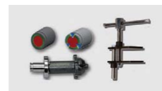
FOT. 16. NARZĘDZIE DO WCISKANIA TOCZKA. TŁOCZKI W ZACISKACH EPB NALEŻY WCISKAĆ (NIE WOLNO ICH WKRĘCAĆ)
