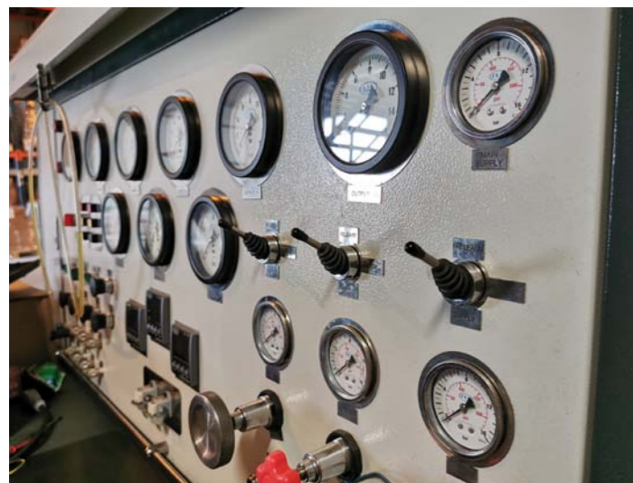
MASZYNA DO BADANIA CZĘŚCI UKŁADÓW PNEUMATYCZNYCH
