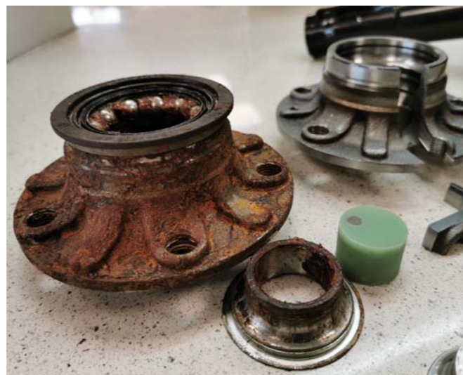
PIASTA KOŁA PO BADANIACH KOROZYJNYCH
