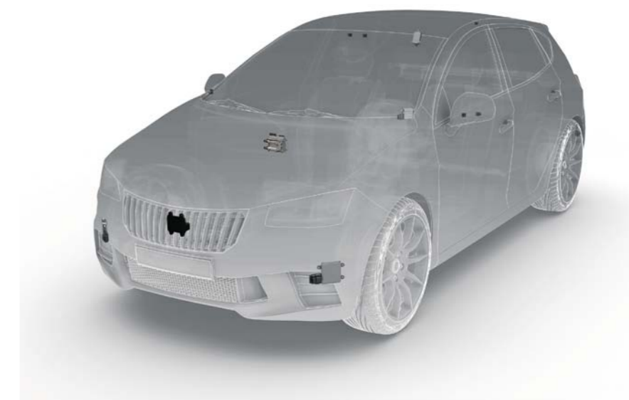
ZF COPILOT – ZINTEGROWANY SYSTEM NOWEJ GENERACJI, POZIOMU 2+, DO ZAAWANSOWANEGO WSPOMAGANIA KIEROWCY. SERCEM SYSTEMU JEST KOMPUTER ZF PROAI, BAZUJĄCY NA PROCESORZE NVIDIA DRIVE XAVIER
