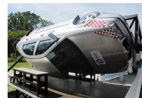
ZNAJDUJĄCE SIĘ W KABINIE GUMOWE PIŁKI SYMULOWAŁY ZACHOWANIE MAŁYCH PRZEDMIOTÓW PODCZAS DACHOWANIA
