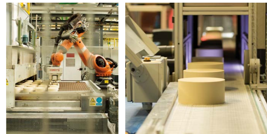
ZAUTOMATYZOWANA LINIA PRODUKCJI BŁOKÓW KATALITYCZNYCH
