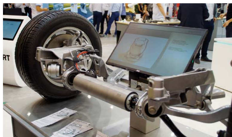
MECHATRONICZNY STABILIZATOR OSI PRZEDNIEJ BMW NA STOISKU FIRMY SCHAEFFLER STANOWIŁ NOWATORSKĄ KONSTRUKCJĘ MARKI FAG, ZNAJĘJ Z PIECZOŁOWITEGO PRZYGOTOWYWANIA ZESTAWÓW NAPRAWCZYCH
