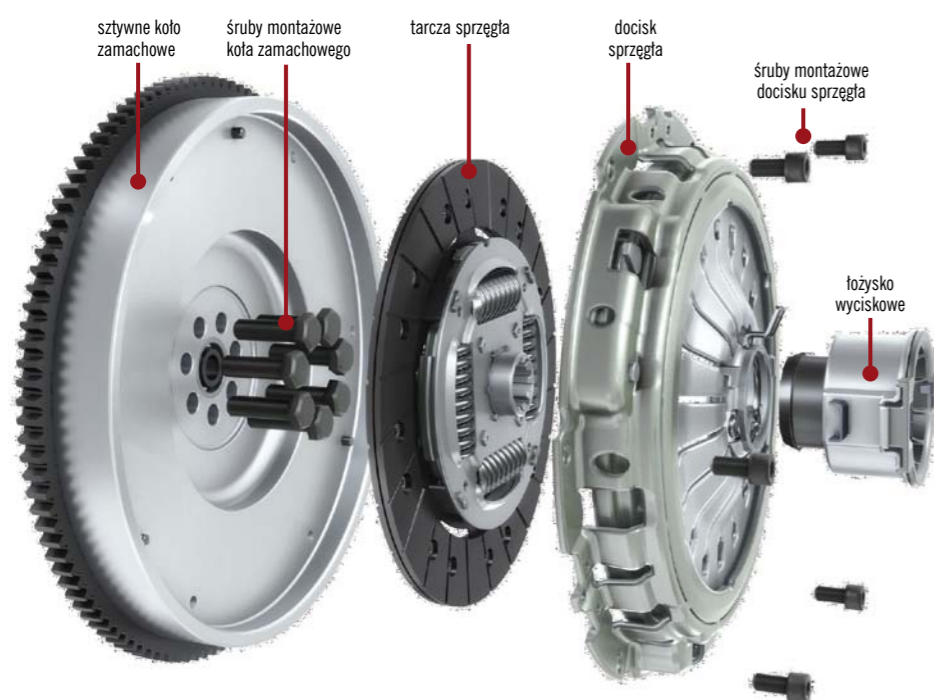
RYS. 1. BUDOWA SPRZĘGŁA K4P
