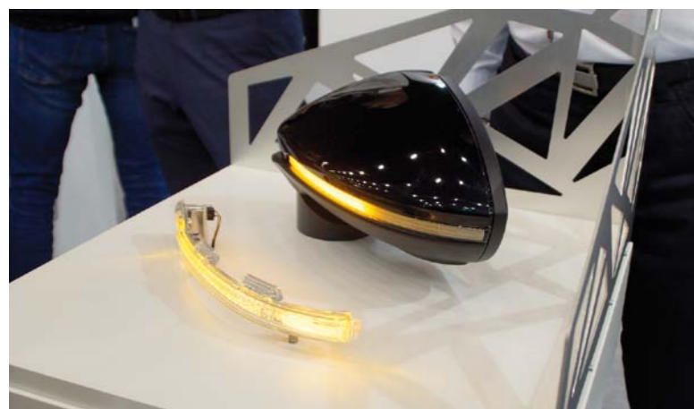
DYNAMICZNY KIERUNKOWSKAZ LEDDRIVING Z HOMOLOGACJĄ ECE PRODUKOWANY PRZEZ FIRMĘ OSRAM
