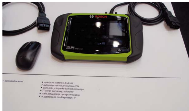
BAZUJĄCY NA SYSTEMIE ANDROID NOWY TESTER BOSCH KT250 Z 7-CALOWYM EKRANEM DOTYKOWYM ZAPEWNIŁ AUTO-MATYCZNY ODCZYT NUMERU VIN
