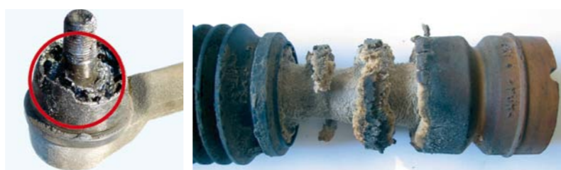
USZKODZENIA ELEMENTÓW PODWOZIA SPOWODOWANE KORYZJĄ
