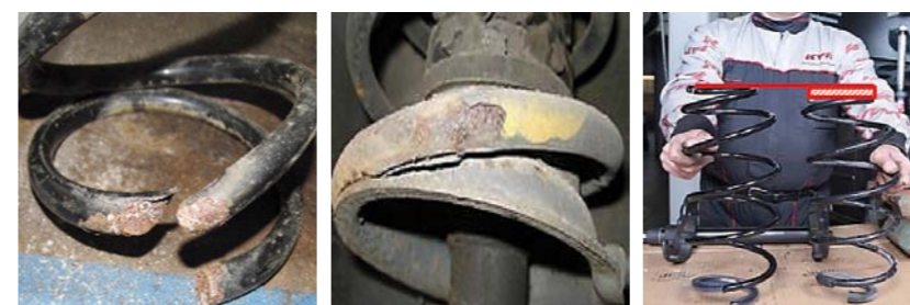
USZKODZENIA SPRĘŻYN ZAWIESZENIA
