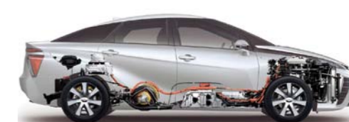
TOYOTA MIRAI ZASILANA WODOREM – WIDOK, SILNIK I SCHEMAT ROZMIESZCZENIA PODZESPOŁÓW W POJEZDZIE
