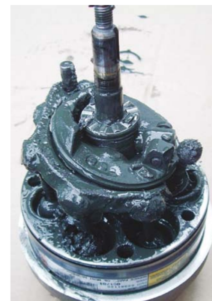
ZNISZCZONY ZESPÓŁ TŁOKÓW SPRĘŻARKI, KTÓRY ULEGŁ USZKODZENIU NA SKUTEK BRAKU SMAROWANIA. OLEJ USUNIĘTY ZE SPRĘŻARKI BYŁ RZADKI I WYDZIELAŁ NIEPRZYJEMNY CHEMICZNY ZAPACH
