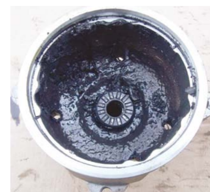
WNĘTRZE USZKODZONEJ SPRĘŻARKI Z OLEJEM, KTÓRY W JEJ WNĘTRZU ZAMIEŃ SIĘ W GĘSTY, CZARNY SZLAM. TEGO TYPU OSAD POWSTAJE PRZY STOSOWANIU W SPRĘŻARKACH DELPHI TECHNOLOGIES NIEZALECANYCH OLEJÓW ESTROWYCH, KTÓRE W WYSOKIEJ TEMPERATURZE ZMIENIAJĄ SWOJĄ KONSYSTENCJĘ
