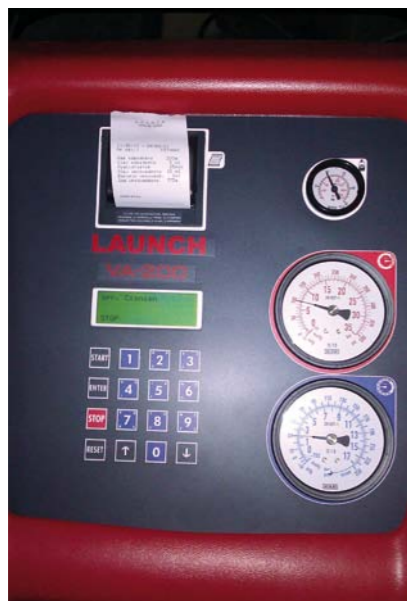
STANDEM W AUTOMATYCZNYCH STACJACH SERWISOWYCH JEST BAZA DANYCH PARAMETRÓW I WBUDOWANA DRUKARKA
