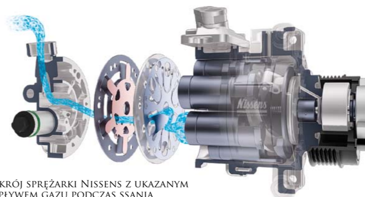
PRZEKRÓJ SPRĘŻARKI NISSENS Z UKAZANYM PRZEPŁYWEM GAZU PODCZAS SPRĘŻANIA. WIDAC SKOMPLIKOWANĄ STRUKTURĘ WEWNĘTRZNY SPRĘŻARKI, NA KTÓREJ OSADZA SIĘ OLEJ, PRZEZ CO NIE JEST MOŻLIWE CAŁKOWITE OPRÓŻNIENIE JEJ Z OLEJU
