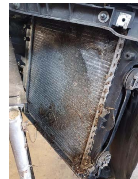
PRZYKŁADY ZANIECZYSZCZENIA SKRAPLACZA
