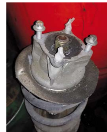
USYTUOWANIE PODUSZKI W KOLUMNIE RESORUJĄCO-AMORTYZUJĄCEJ
