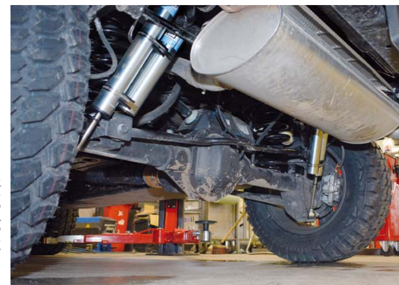
WIDOK ZMODYFIKOWANEGO ZAWIESZENIA TYLNEGO W SAMOCHODZIE JEEP
