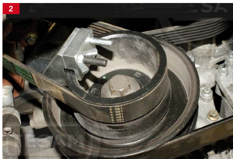
1, 3. ADAPTER DO ZDEJMOWANIA PASKA ALTERNATORA, 2, 4. ADAPTER DO ZAKŁADANIA PASKA ALTERNATORA, 5, 6. NAKRĘTKI KONTRUJĄCE
