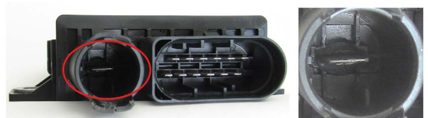
STEROWNIK PRACY ŚWIEC ŻAROWYCH NIE MUSI BYĆ PRZYCYNĄ NIESPRAWNOŚCI UKŁADU
