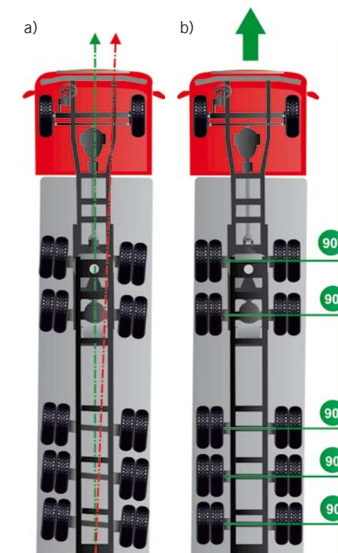
GEOMETRIA CIĄGNIKA SIODŁOWEGO Z NACZEPĄ: A) NAPRAWA NIEPRAWIDŁOWA, B) NAPRAWA PRAWIDŁOWA
