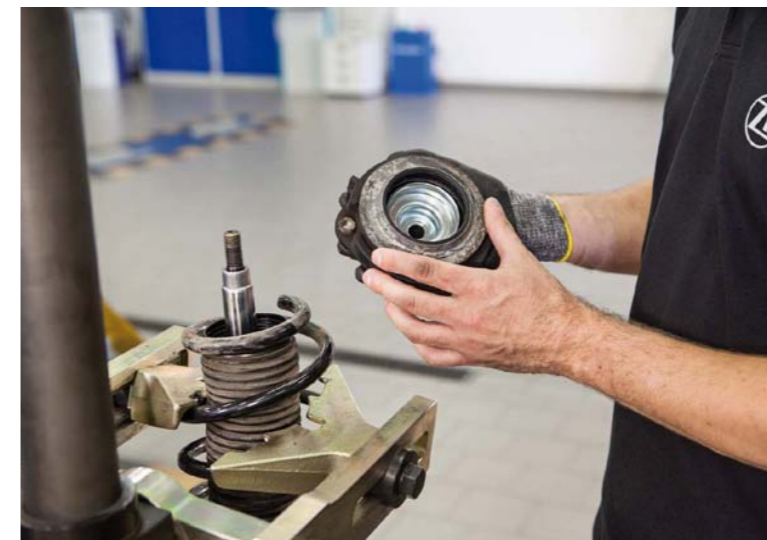
ROZBIÓRKA ZAWIESZENIA JEST KONIECZNA DLA SPRAWDZENIA ZUŻYCIA POŁĄCZEŃ
