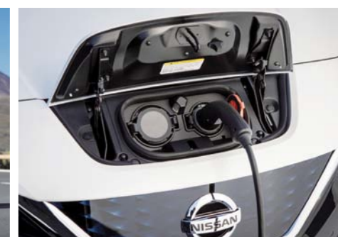
NISSAN LEAF. Z PRAWY: ZŁĄCZE ŁADOWANIA AKUMULATORA Z SIECI ZEWNĘTRZNEJ
