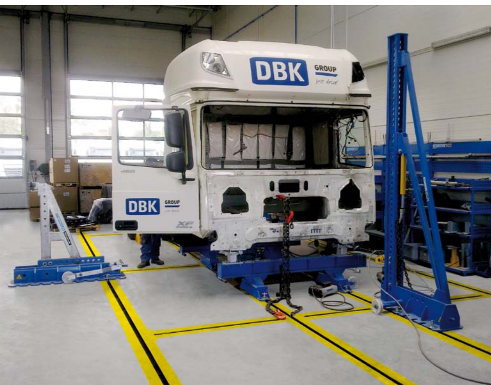
ZDEMONTOWANA KABINA CIĄGNIKA SIODŁOWEGO NA OSOBNYM STANOWISKU NAPRAWCZYM. Z PRAWY OD GÓRY: PROSTOWANIE FRAGMENTU RAMY I PODGRZEWANIE OBSZARU DEFORMACJI
