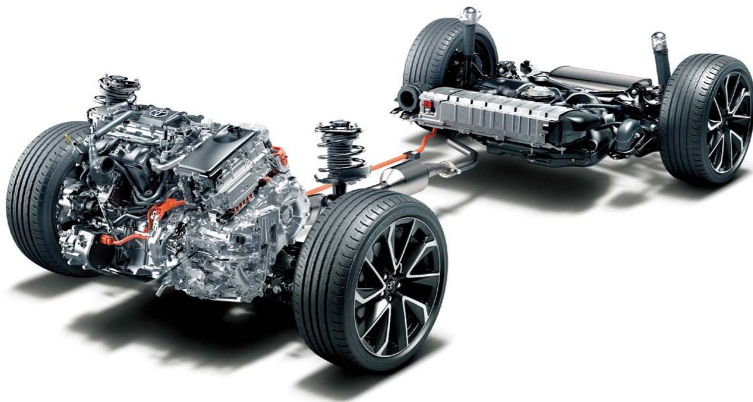
PODWOZIE SAMOCHODU TOYOTA COROLLA SPORT 2018 Z ZASTOSOWANYMI WEWNĘTRZNYMI SPRĘŻYNAMI ODBICIA
