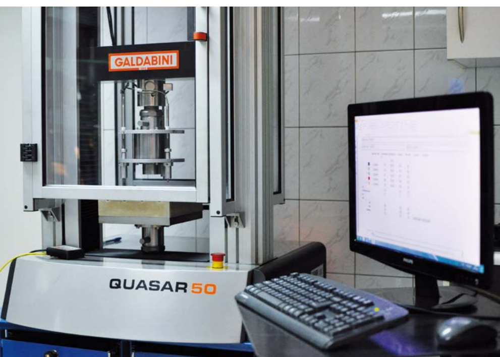
LABORATORIUM TOMEX - WIELOFUNKCYJNE URZĄDZENIE BADAWCZE QUASAR 50 GALDABINI
