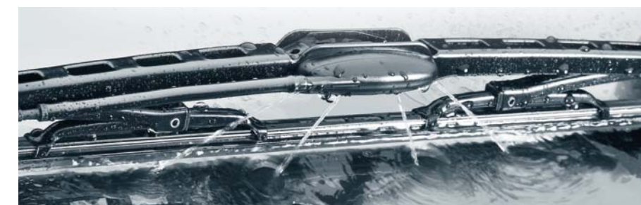
DYSZA SPRYSKIWACZA SZYBY ZINTEGROWANA Z RAMIENIEM WYCIERACZKI
