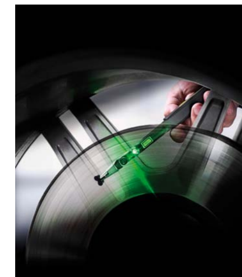
LASEROWE SKANOWANIE POWIERZCHNI CIERNEJ TARCZY
