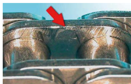
CHARAKTERYSTYCZNE WEWNĘTRZNE I ZEWNĘTRZNE OTARCIA PŁYTEK
