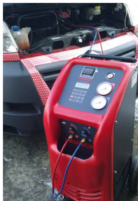
OBSŁUGA SERWISOWA MOŻLIWA JEST PO PRZYŁĄCZENIU PRZEWODÓW CIŚNIENIOWYCH STACJI DO PUNKTÓW SERWISOWYCH UKŁADU W POJEZDZIE
