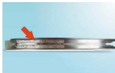
UBYTKI MATERIAŁU METALOWEJ PROWADNICY
