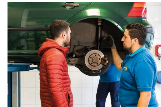
SKORODOWANE SPRĘŻYNY WYMAGAJĄ WYMIANY ZE WZGLĘDU NA BEZPIECZEŃSTWO JAZDY
