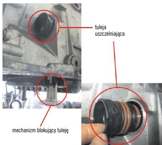
RYS. 9. DEMONTAŻ – ROZŁĄCZENIE GNIAZDA ELEKTRYCZNEGO SKRZYNI BIEGÓW
