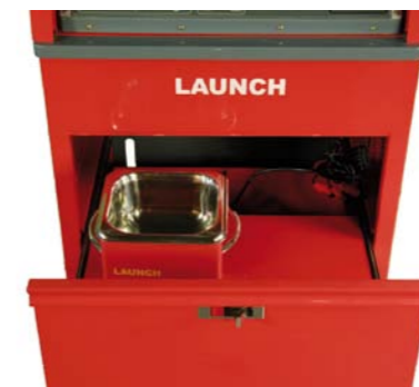
MYJKA ULTRADŹWIĘKOWA DO USUWANIA TRWAŁYCH OSADÓW
