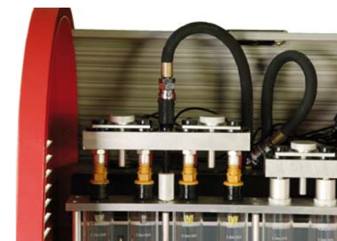
LISTWA DOPROWADZAJĄCA PALIWO DO TESTOWANYCH WTRYSKIWCZY
