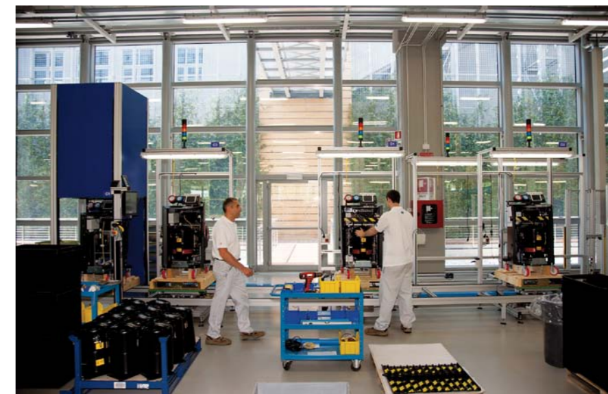
LINIE MONTAŻU STACJI KONFORT PRZEZNACZONYCH DO OBSŁUGI KLIMATYZACJI SAMOCHODOWYCH
