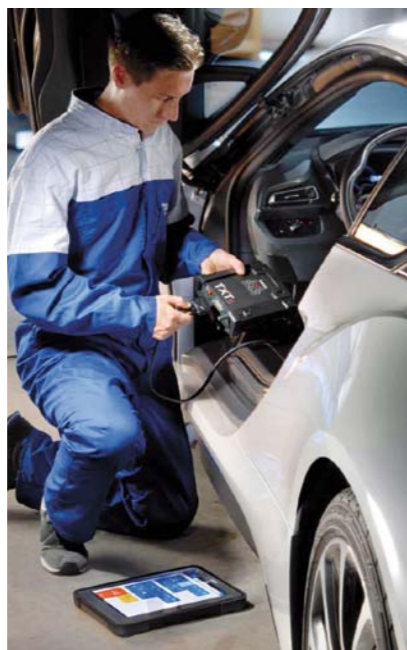
URZĄDZENIE DIAGNOSTYCZNE AXONE NEMO Z 12-CALOWYM EKRANEM WYPOSAŻONE JEST W PAKIET CZUJNIKÓW I MODUŁ GPS
