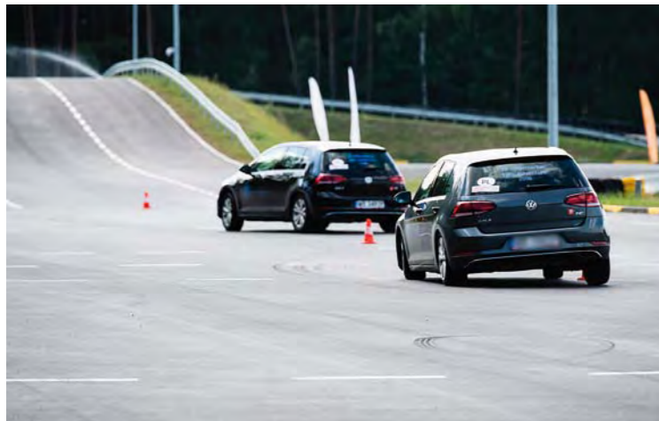
SLALOM WYKONYWANY Z DUŻĄ PRĘDKOŚCIĄ MIĘDZY CIASNO ROZSTAWIONYMI PACHOLEKAMI UJAWNIA WADY HAMULCÓW I ZAWIESZEŃ
