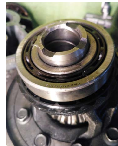
WSPÓŁPRACUJĄCE CIERNIE SYNCHRONIZATORY POTRZEBUJĄ WIĘKSZEJ LEPKOŚCI OLEJU NIŻ KOŁA ZĘBATE I ŁOŻYSKA
