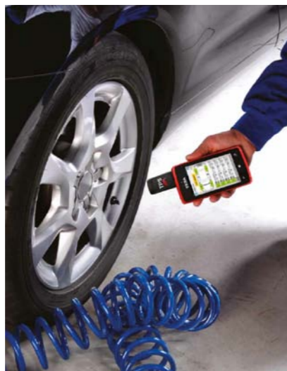
AXONE S TPS/FAST-FIT UMOŻLIWIA SPRAWDZENIE SYSTEMÓW KONTROLI CIŚNIENIA W OGUMIENIU ORAZ PROGRAMOWANIE CENTRALEK TPMS
