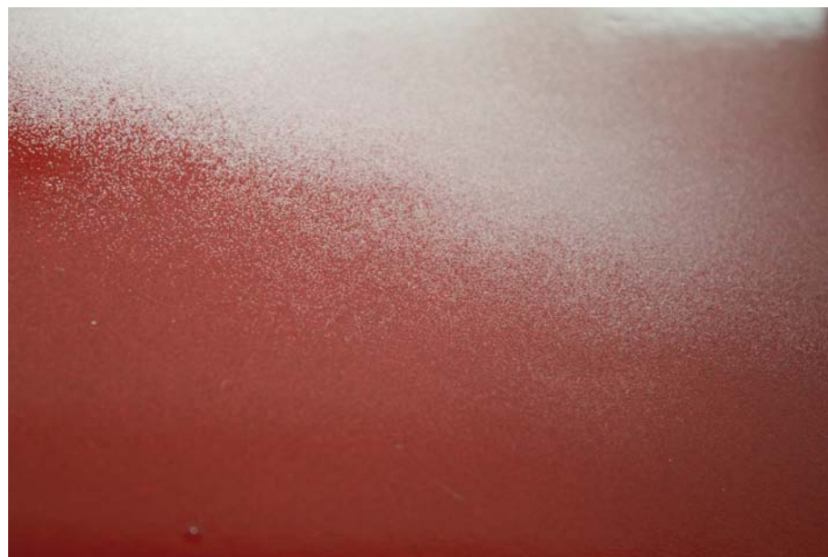
OSIADANIE MGŁY LAKIERNICZEJ W SĄSIĘDZTWIE NAPRAWIANEJ STREFY
