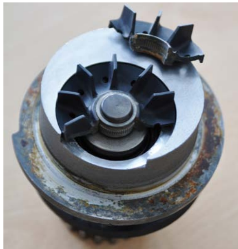
RYS. 4. USZKODZONY WIRNIK POMPY UKŁADU CHŁODZENIA
