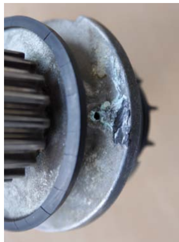
RYS. 5. ZAŚLEPIENIE OTWORU ODPOWIETRZAJĄCEGO SILIKONEM
