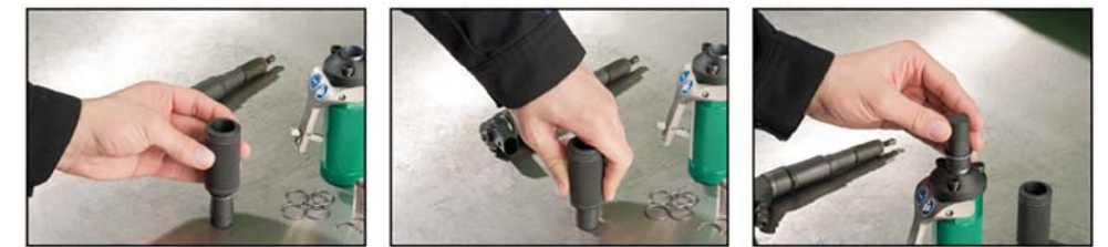
NASADZANIE NOWEGO PIERŚCIEŃ NA TULEI OCHRONNEJ PRZYRZĄDU
