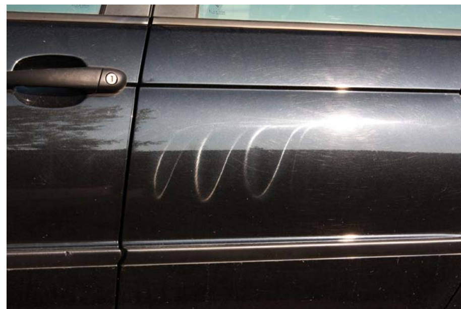
CZĘSTO SPOTYKANA WADA LAKIERNICZA NAZYWANA „EFEKTEM HOLOGRAMU”
