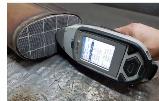
ANALIZA ZAWARTOŚCI METALI SZLACHETNYCH W FILTRZE CZĄSTEK STAŁYCH
