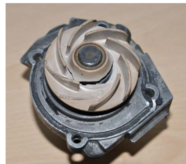
RYŚ. 1. USZKODZENIE WIRNIKA W WYNIKU NIEPRAWIDŁOWEGO MONTAŻU
