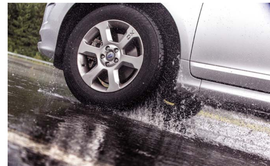
WRAZ ZE ZUŻYCIEM BIEŻNIKA ZNACZNIE WZRASTA RYZYKO AKWAPLANINGU
