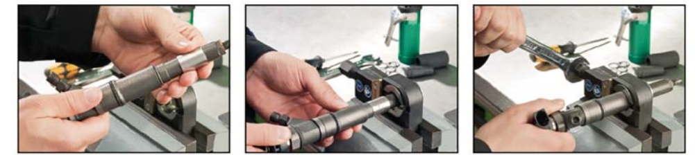
DEMONTAŻ PIERŚCIEŃ Z KORPUSU WTRYSKIWACZA Z WYKORZYSTANIEM METODY PRZECINANIA
