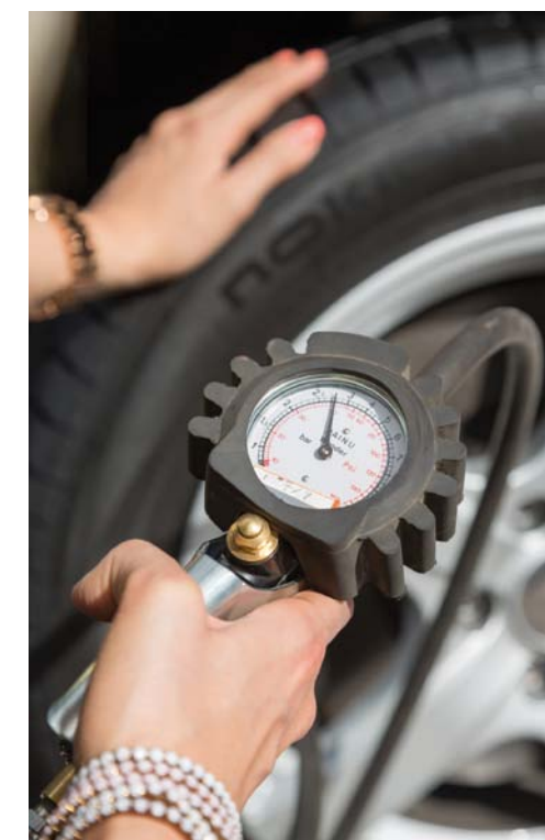
CIŚNIENIE W OPONACH NALEŻY SPRAWDZAĆ I KORYGOWAĆ CO TRZY TYGODNIE. ZBYT NISKIE SKUTKUJE ZWIĘKSZENIEM ZUŻYCIA PALIWA
