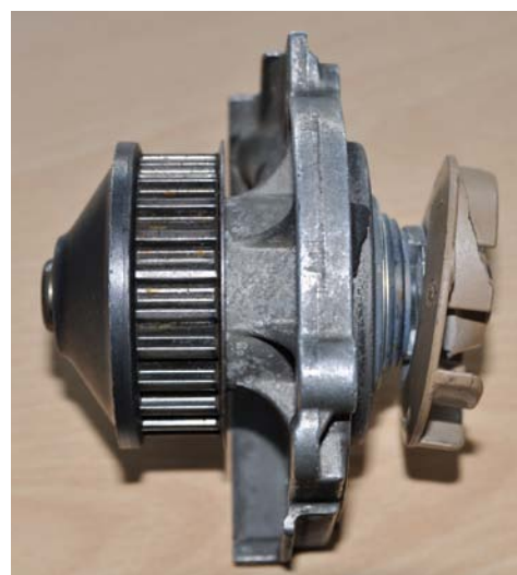
RYŚ. 2. OSTRA KRAWĘDŹ WEWNĘTRZNA KOŁA POMPY
