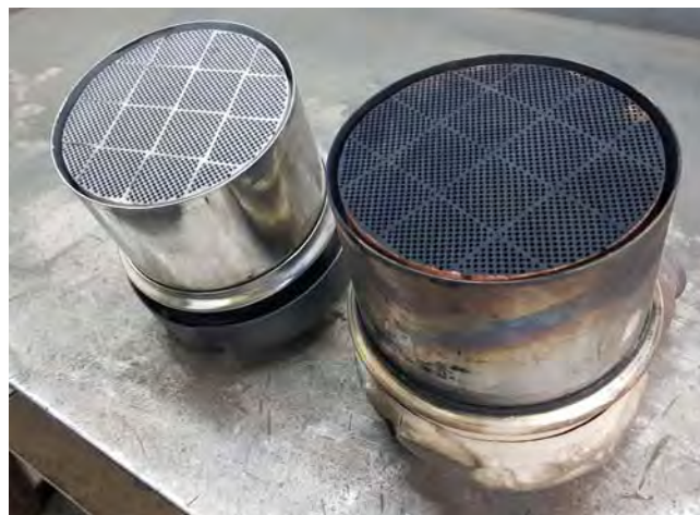
Z PRAWY: FILTR CAŁKOWICIE ZUŻYTY. Z LEWEJ: ZREGENEROWANY DO NATYCHMIASTOWEGO UŻYCIA
