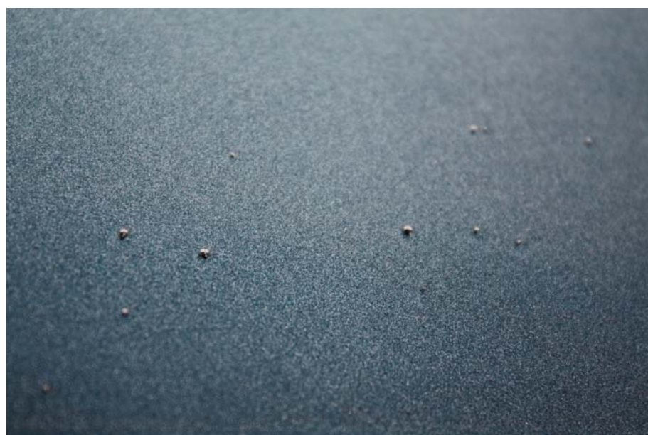
OBECNOŚĆ ZANIECZYSZCZEŃ W APLIKOWANYM MATERIALE LAKIERNICZYM
